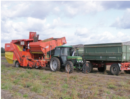
Figura 9.9. Cosechadora de arrastre de una hilera con bunker acumulador de 5,5 t. Alemania.
