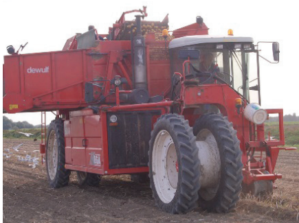
Figura 9.11. Automotriz de dos hileras con bunker acumulador de 11 m 3 . Holanda.
