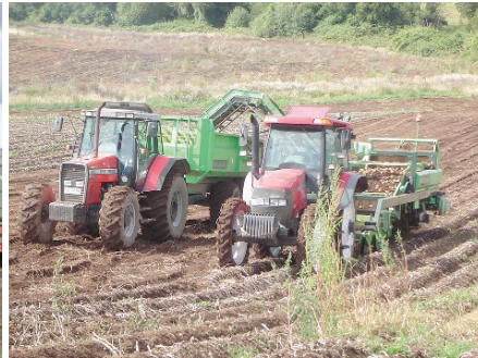
Figura 9.10. Arrancadora de dos hileras con descarga lateral. Purranque, Región de los Lagos.
