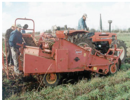
Figura 9.8. Arrancadora y ensacadora de papa, de una hilera. Vilcún, Región de La Araucanía.
