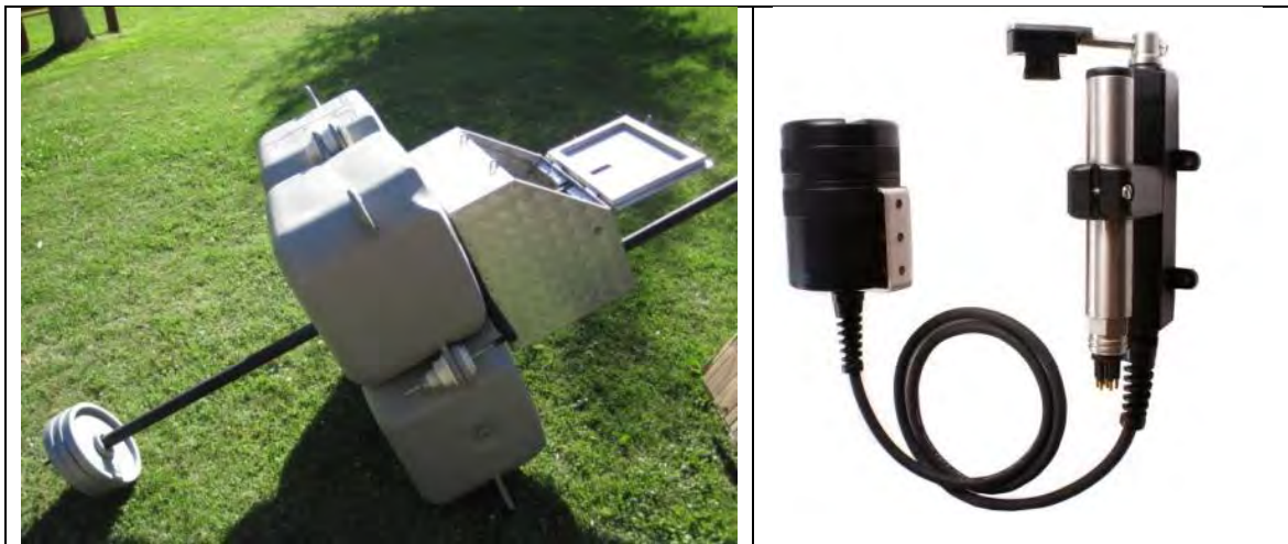
Figura N° 63 Izquierda: Estructura de la boya diseñada para el embalse Rapel. Derecha: Sensor fluorómetro Turner para clorofila a con sistema de limpieza automático (hydrowiper).
