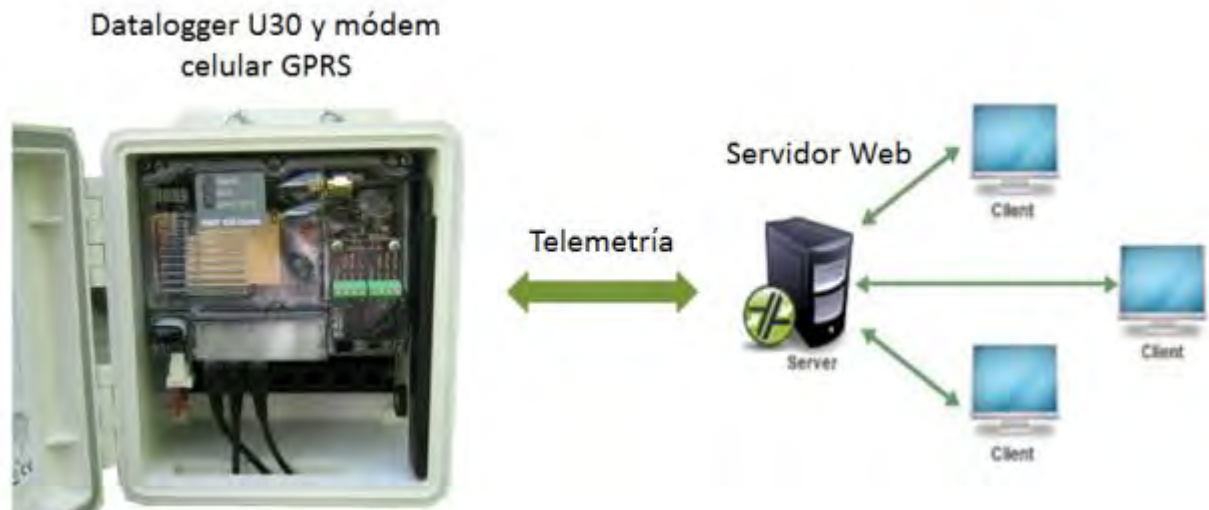
Figura N° 69 Esquema de transmisión de datos desde el datalogger con módem GPRS y el acceso a los datos mediante un servidor web.
