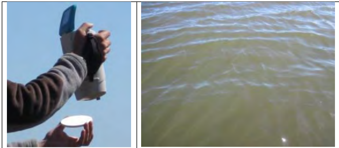
Figura N° 52 Espectrorradiómetro ASD HH2, y mediciones en cuerpos acuáticos.
