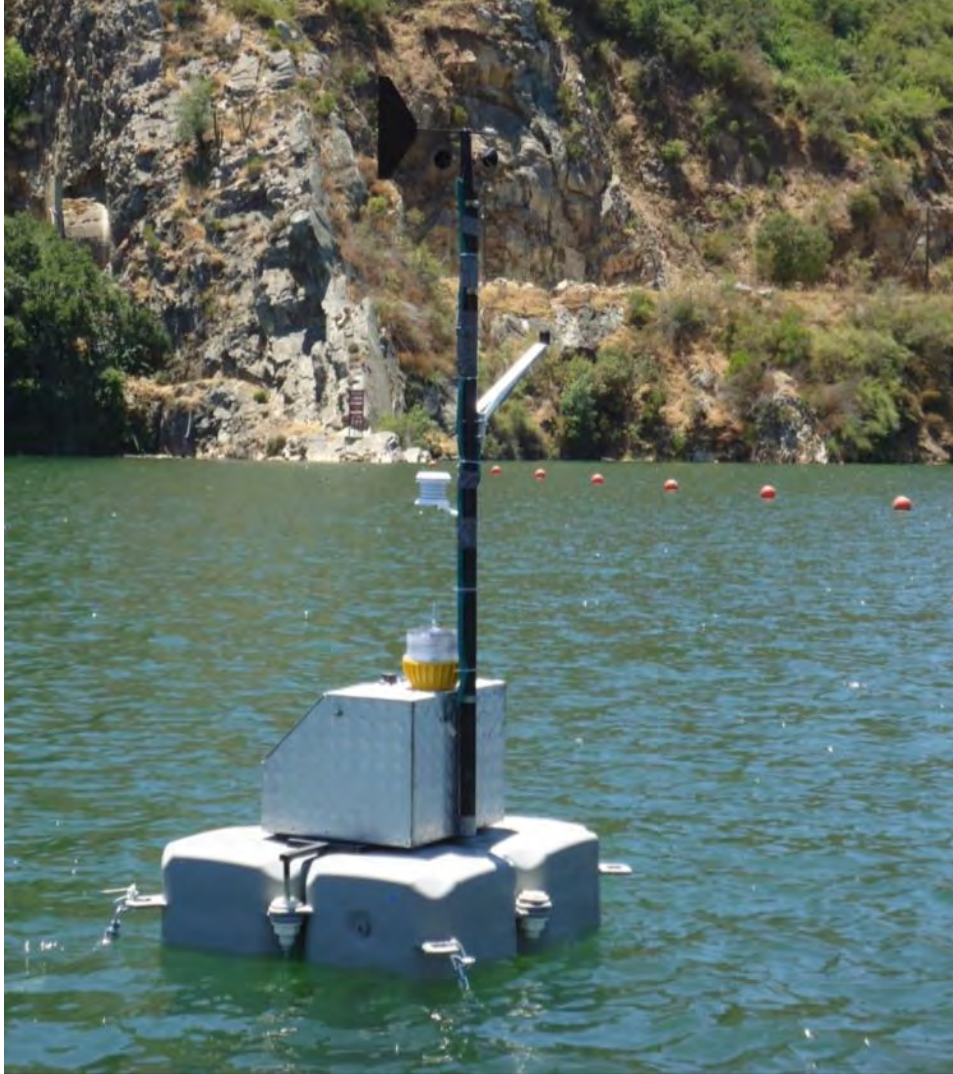
Figura N° 68 Boya telemétrica instalada en embalse Rapel.
