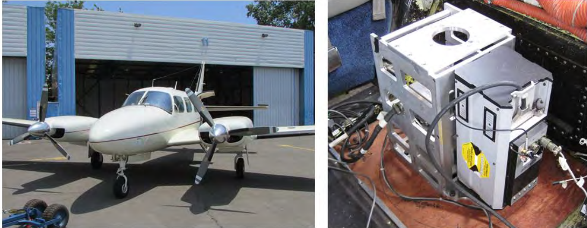
Figura N° 40 Plataforma aérea bimotor Piper Navajo y sensor hiperespectral aerotransportado AISA Eagle Specim para levantamiento de imágenes en el rango visible e infrarrojo cercano. Avión y sensor de propiedad del Centro de Ecología Aplicada.
