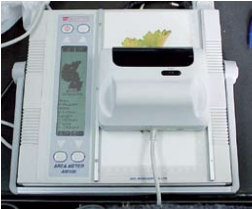
Análisis de muestras para determinación de área foliar, mediante el uso del instrumento de medición AM100 Portable Area Meter Instrument
