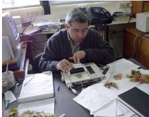
Análisis de muestras para determinación de área foliar, mediante el uso del instrumento de medición AM100 Portable Area Meter Instrument
