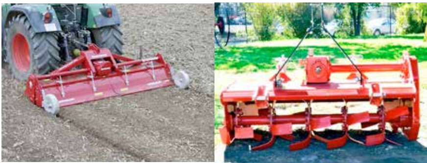
Figura 5.11. Rotovator y un detalle de su interior.
