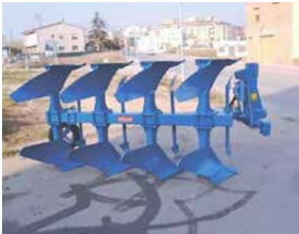
Figura 5.2 a. Arado de vertedera de vuelta y vuelta.
