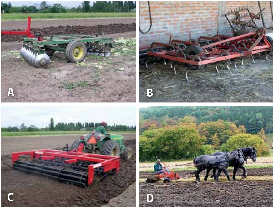
Figura 5.5. Diferentes implementos para labores de labranza secundaria. (a) Rastra de discos offset. (b) Vibrocultivador. (c) Vibrocultivador trabajando. (d) Rastra de tiro animal.
