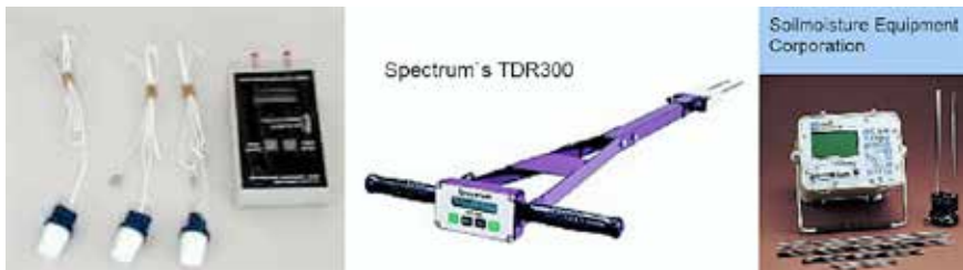
Figura 7.5. Bloques de yeso y sensores de capacitancia.
