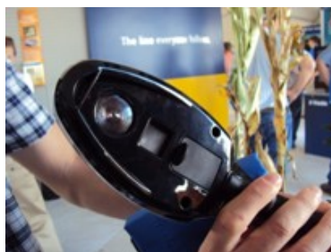
Figura 6. sensor Green seeker para mediciones manuales de índice verde.
