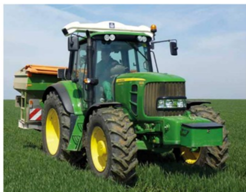
Figura 14. N-Sensor de Yara. (a) el sensor para el sensoramiento de los índices vegetativos va montado en el techo de tractor. (b) Dicho sensor mide en forma oblicua a medida que se realiza el escaneo y la aplicación en tiempo real en el campo. Fuente imagen: Yara Internacional
