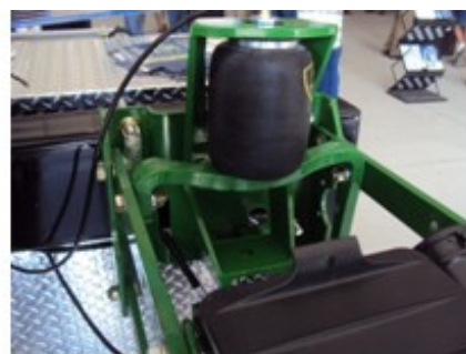
Figura 9. Fotografía de los dos sistemas de copiado de los cuerpos de la sembradora, a la izquierda se encuentra el sistema hidráulico y a la derecha el sistema de pulmón neumático.
