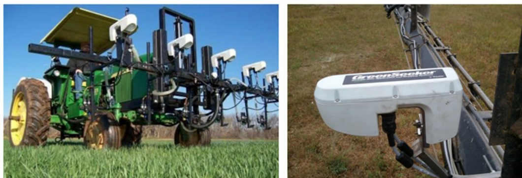
Figura 15. (a) montaje de sensores GreenSeeker al frente de la maquinaria. (b) detalle de sensor, el cual es ubicado en forma perpendicular al cultivo. Imagen Fuente: Vellidis y Lincopresicion.
