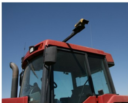
Figura 18. CropSpecTM de Topcon (a) el sensor va montado en el techo del tractor para el sensoramiento de los índices vegetacionales. Este sensor mide en forma oblicua a medida que se realiza el escaneo y la aplicación en tiempo real en el campo. Fuente imagen: Topcon
