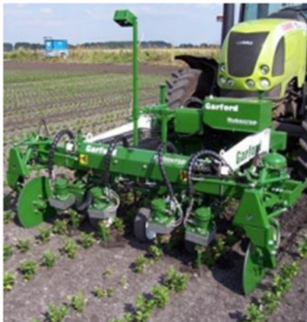
Figura 36. Robocrop, tractor robotizado de la empresa Tillett and Hague Technology Ltd. , para eliminar la maleza de forma mecánica sin dañar el cultivo útil.
