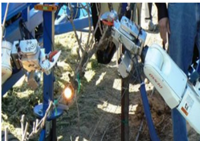
Figura 37. Brazos robóticos del Robot podador de viñedos.
