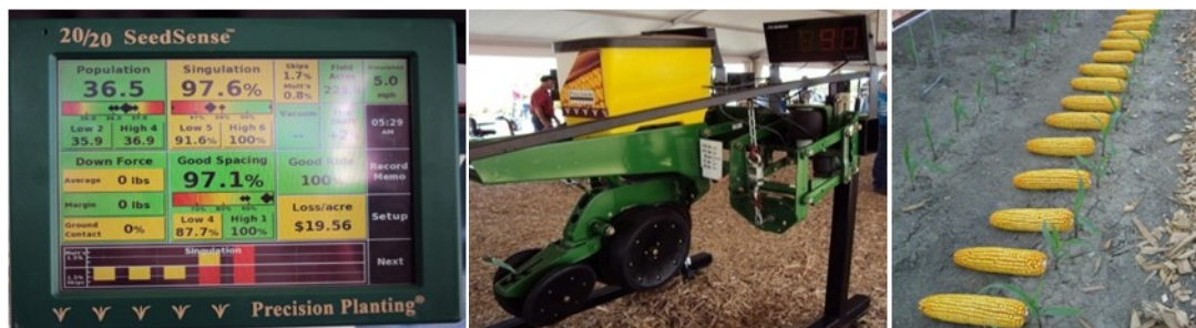
Figura 26. Sembradora de alta precisión de la empresa Precision Planting (EEUU).
