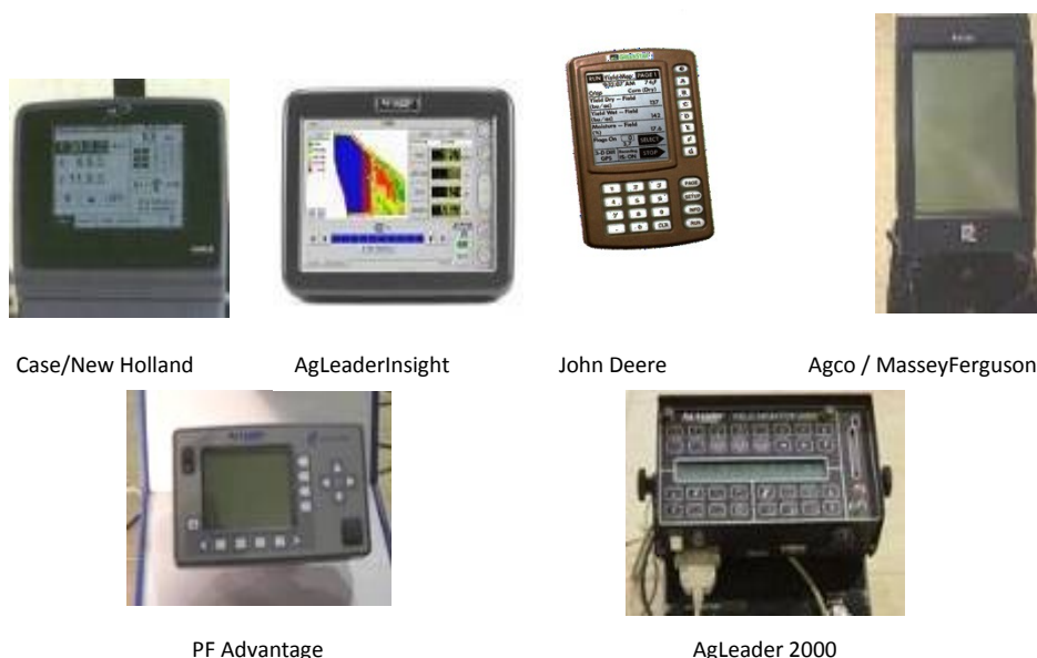
Figura 19. Monitores de rendimiento más difundidos.
