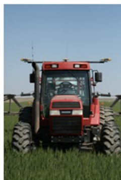
Figura 18. CropSpecTM de Topcon (a) el sensor va montado en el techo del tractor para el sensoramiento de los índices vegetacionales. Este sensor mide en forma oblicua a medida que se realiza el escaneo y la aplicación en tiempo real en el campo. Fuente imagen: Topcon
