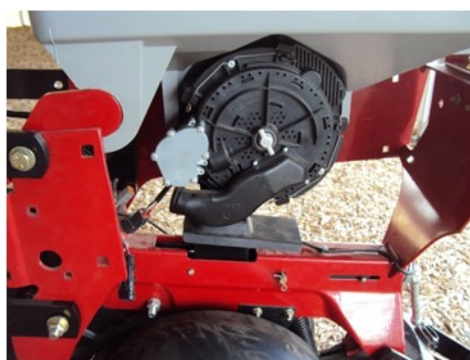
Figura 2. motores eléctricos de 3 amperes que producen el giro de los distribuidores.
