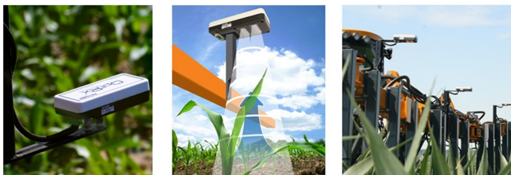
Figura 17. Montaje de sensores OptRx al frente de la maquinaria y detalle de sensor, el cual es ubicado en forma perpendicular al cultivo. Fuente figura: Holland Scientific y AgLeader
