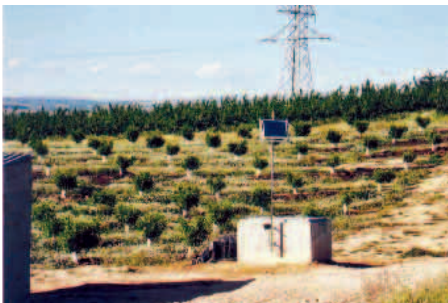
Para reducir los costos de instalación, los sistemas se alimentan de energía solar.
