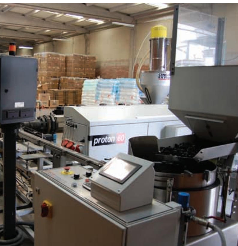
Línea de extrusión de mangueras de goteo integrado.
