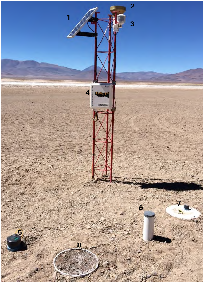
Figura 4-2: Componentes de los lisímetros instalados. Lisímetro MAR-2. Modif. Fase 2, DGA-Arcadis (2015)
