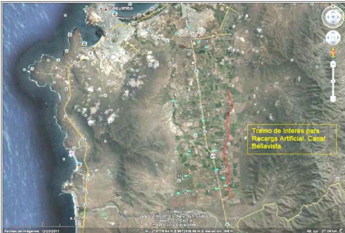
Figura 14: Tramo de Canal Bellavista considerado para realizar recarga artificial del acuífero
