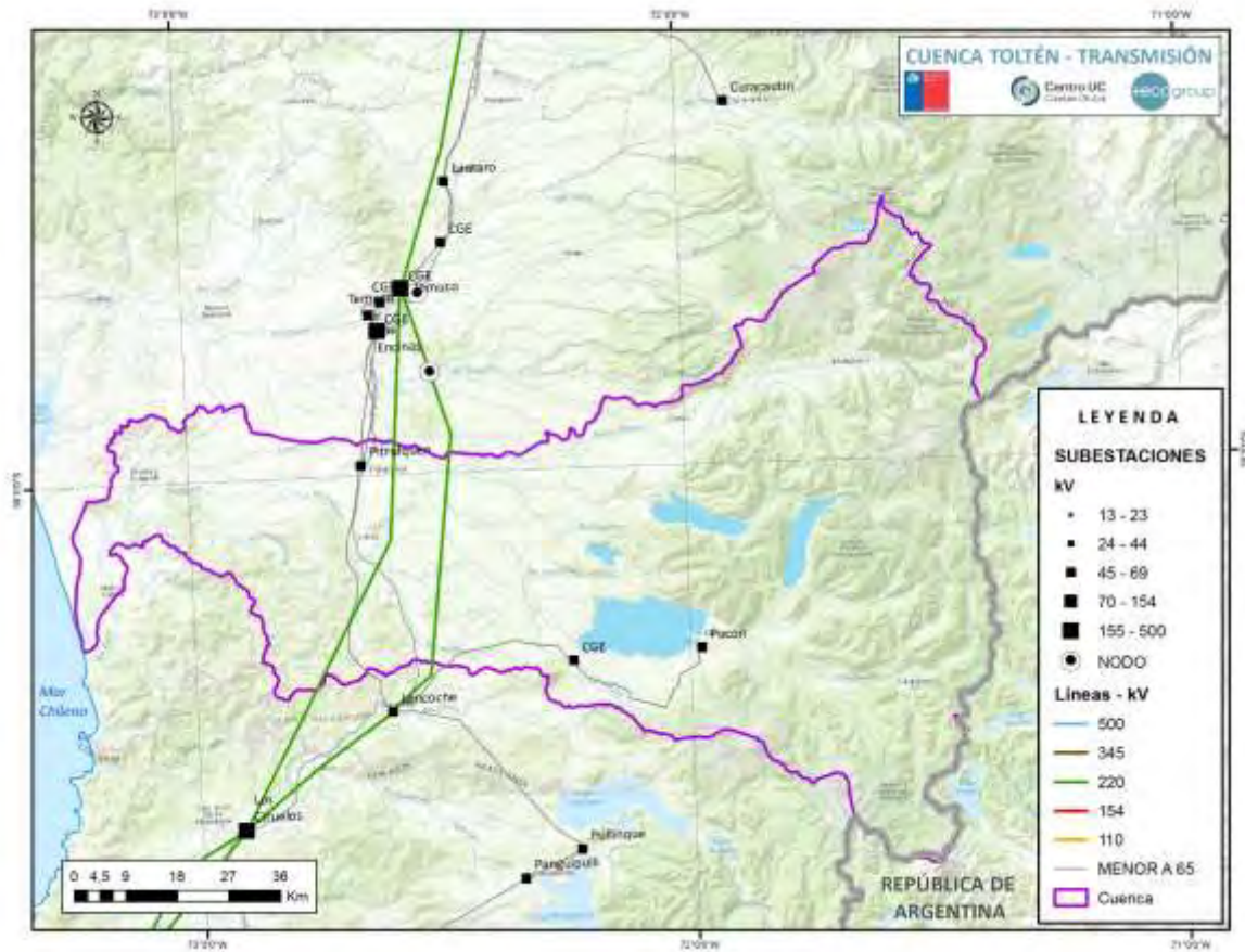
Figura 30. Esquema de las principales líneas de transmisión, nodos y subestaciones en la cuenca del río Toltén
