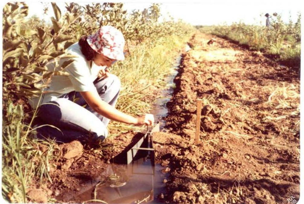
Evaluación del riego por surcos : vista de la canaleta " Parshall " de 1 pulg. de garganta ( foto superior ) y de la medición del nivel de agua para el cálculo del caudal. Surcos en frutales, Parcela Loreley ( suelos serie Talca )
