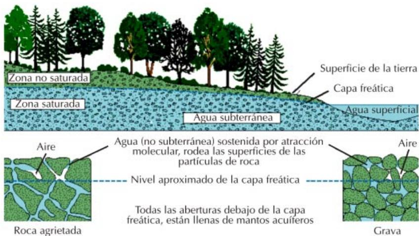
Figura 2. Distribución del agua en el subsuelo, en una condición saturada.
