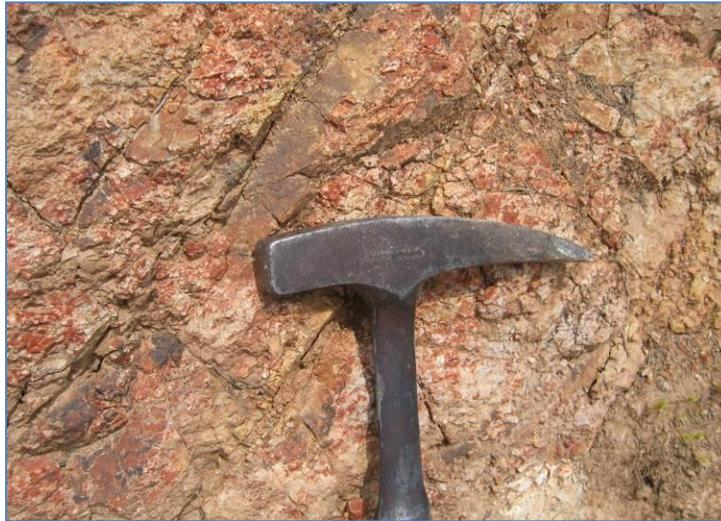
**Fotografía 1-6. Detalle de la textura de la toba, aguas arriba de la cerrada, en la margen izquierda del valle.**
