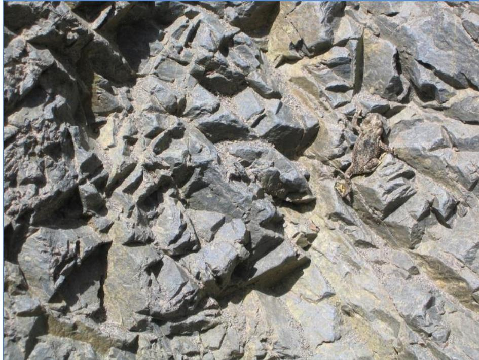
**Fotografía 1-4. Andesitas. Detalle de la textura de la roca**
