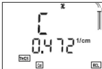
3. Volver al modo de medición: presionar la tecla <M> cuando en el display aparece la constante correcta.
