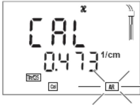
5. Volver al modo de medición: Presionar la tecla <M>. La constante celular determinada es adoptada para la medición.
