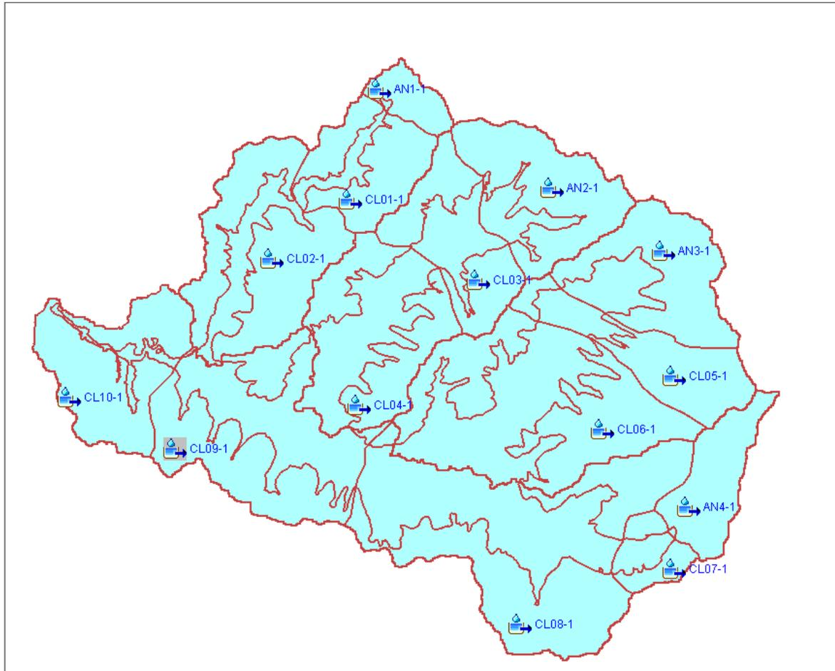
**FIGURA 9-20 SUBCUENCAS UTILIZADAS EN LA SIMULACIÓN EN HEC-HMS**
