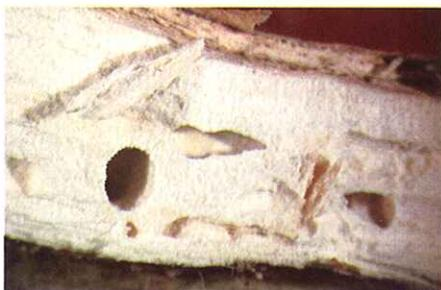
Figura 38. Orificio y galería por daño de *Micrapate scabrata*.
