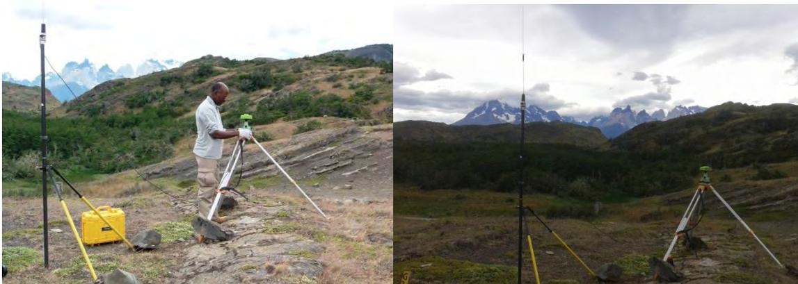
Figura 10.5. Configuración Base RTK en uno de los PR utilizados.
