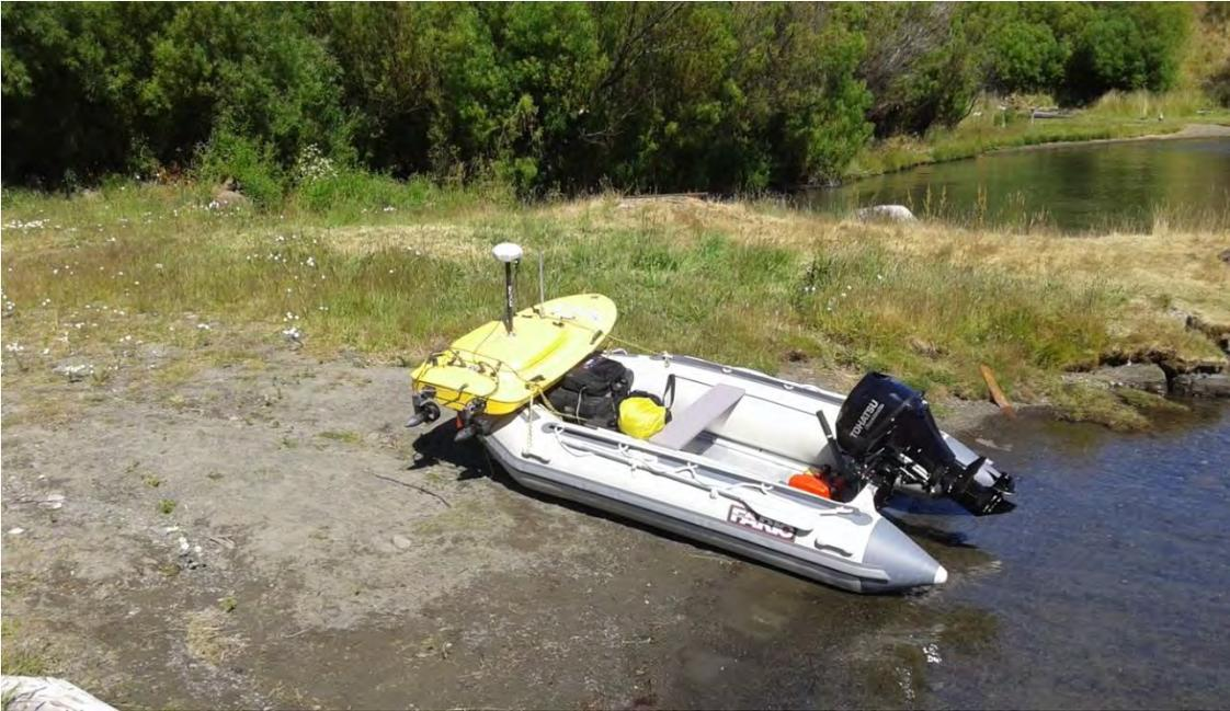
Figura 6.6. Equipos utilizados para realizar los sondeos batimétricos.
