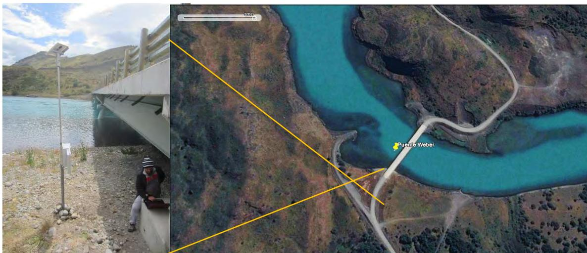
Figura 5.8. Izquierda: foto del lugar de instalación. Derecha: Puente Weber, sobre río Paine. El círculo amarillo / violeta indica la zona de instalación de la estación fluviométrica
