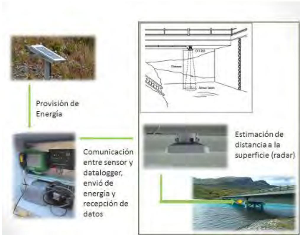
Figura 5.11. Principio de funcionamiento de estación fluviométrica instalada en río Paine, Parque Nacional Torres del Paine.
