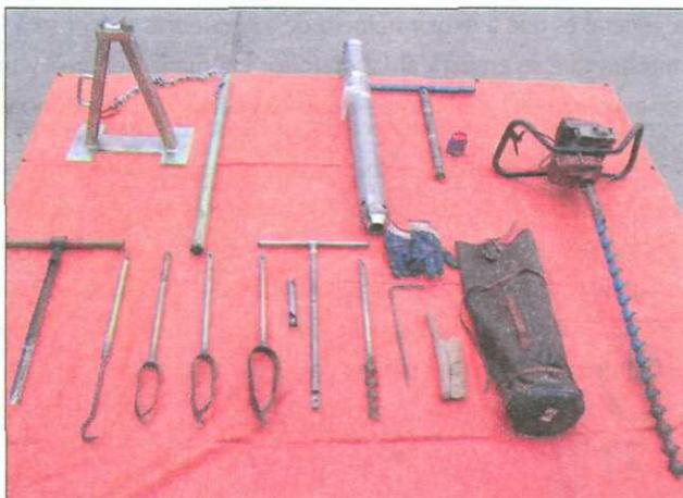
**Figura 6.** Barrenos y muestreadores cilíndricos comúnmente utilizados para extraer muestras de suelo.
