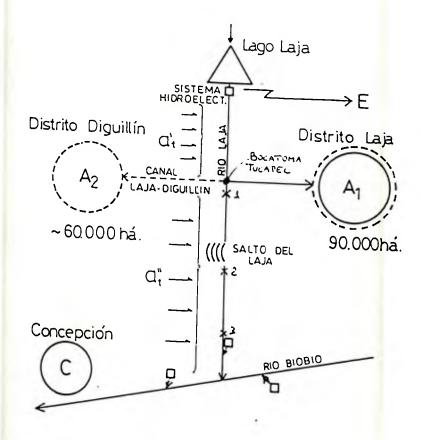
Fig.1 - El sistema involucrado en la cuenca d<mark>e</mark>l Biobío por el Proyecto Canal Laja-Diguillín
