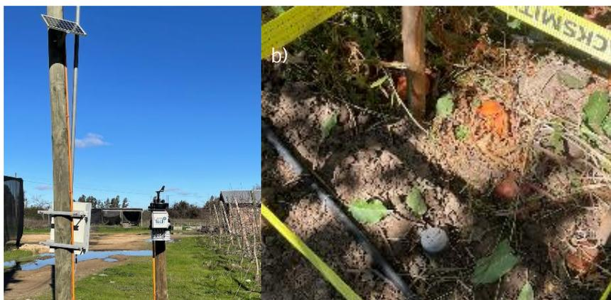
Fotografía 7. Instalación de EMA (a) y sonda de humedad FDR (b) en parcela demostrativa 1 Agrícola Batudahue, Linares, Maule.
