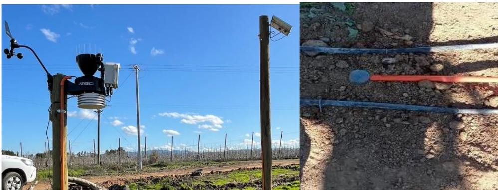
Fotografía 10. Instalación estación EMA y sonda de humedad FDR en parcela demostrativa 2, Agrícola Forli, San Rafael, Maule.
