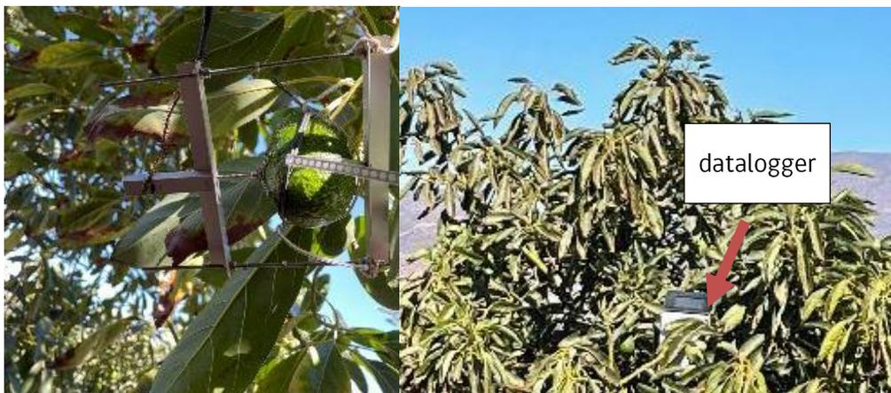
Fotografía 3. Instalación del dendrómetro de fruto en la parcela demostrativa 1, Agrícola El Carmen, Limarí. Foto de la izquierda muestra el dendrómetro instalado y foto de la derecha muestra el datalogger asociado al dendrómetro.
