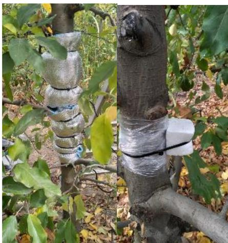
Fotografía 9. Instalación del microtensiómetro en la parcela demostrativa 1 Agrícola Batudahue, Linares, Maule (Derecha: Instalación del microtensiómetro sobre el tronco del árbol, e izquierda: manta protectora y forma final de la instalación para el correcto funcionamiento del sensor).
