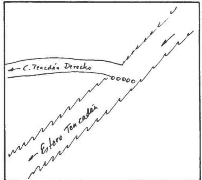
**DESCRIPCION DE LA BOCATOMA** Con barrera de piedra y patas de cabra se desvía un brazo del Estero hacia la bocatoma del canal, de tipo provisoria, frente al predio rol E.T. St. 111 de Salamanca.
