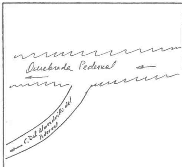
DESCRIPCION DE LA BOCATOMA Con barrera de piedra y patas de cabra se desvía un brazo de la Quebrada hacia la bocatoma del canal, de tipo provisoria, frente al predio rol 247-162. de Salamanca.
