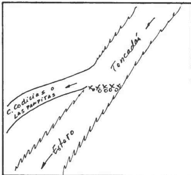
DESCRIPCION DE LA BOCATOMA Con barrera de piedra y patas de cabra se desvía un brazo del Estero hacia la bocatoma del canal, de tipo provisoria, frente al predio, rol E.T. St.115 de Salamanca.
