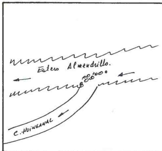
DESCRIPCION DE LA BOCATOMA Con barrera de piedra y patas de cabra se desvía un brazo del Estero hacia la bocatoma del canal, de tipo provisoria, frente al predio rol 247-123 de Salamanca.
