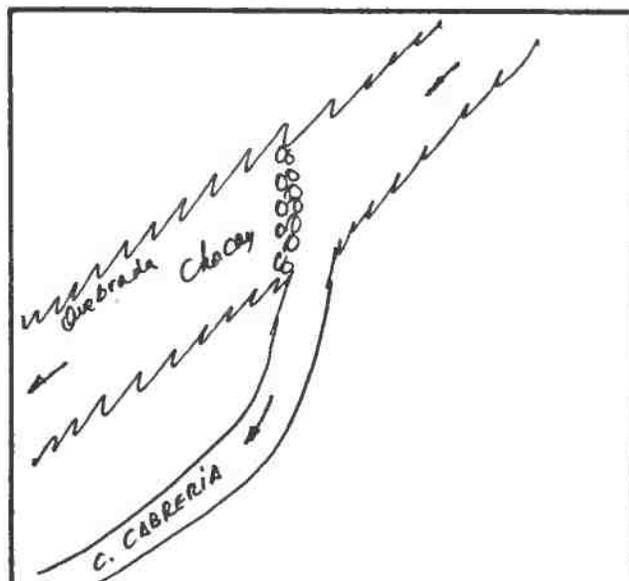
DESCRIPCION DE LA BOCATOMA Con barrera de piedra y patas de cabra se desvía un brazo de la Quebrada hacia la bocatoma del canal, de tipo provisoria, frente al predio rol 246-2 de Salamanca.
