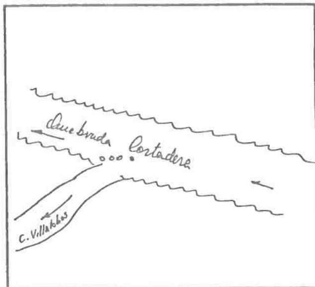
**DESCRIPCION DE LA BOCATOMA** Con barrera de piedra y patas de cabra se desvía un brazo de la Quebrada hacia la bocatoma del canal, de tipo provisoria, frente al predio rol 247-152 de Salamanca.
