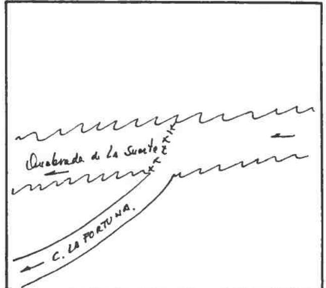
DESCRIPCION DE LA BOCATOMA Con barrera de piedra y patas de cabra se desvía un brazo de la Quebrada hacia la bocatoma del canal, de tipo provisoria, frente al predio rol 246-1 de Salamanca.
