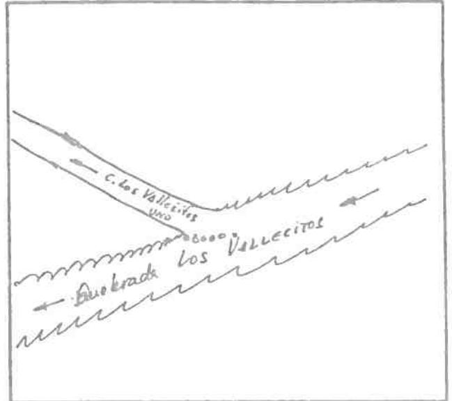
DESCRIPCION DE LA BOCATOMA Con barrera de piedra y patas de cabra se desvía un brazo de la Quebrada hacia la bocatoma del canal, de tipo provisoria, frente al predio rol 247-6 de Salamanca.
