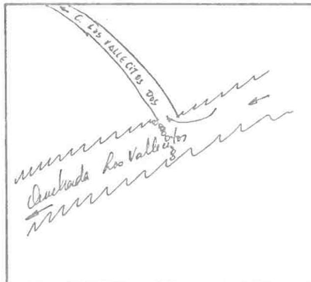
DESCRIPCION DE LA BOCATOMA Con barrera de piedra y patas de cabra se desvía un brazo de la Quebrada hacia la bocatoma del canal, de tipo provisoria, frente al predio rol 247-160 de Salamanca.
