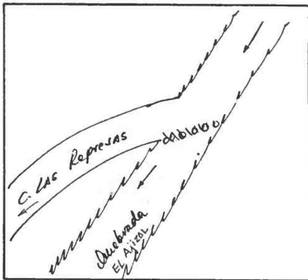
DESCRIPCION DE LA BOCATOMA Con barrera de piedra y patas de cabra se desvía un brazo de la quebrada hacia la bocatoma del canal de tipo provisoria, frente al rol 245-1 de Salamanca.
