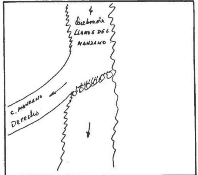
**DESCRIPCION DE LA BOCATOMA** Con barrera de piedra y patas de cabra se desvía un brazo de la Quebrada hacia la bocatoma del canal, de tipo provisoria, frente al rol 246-1 de Salamanca.
