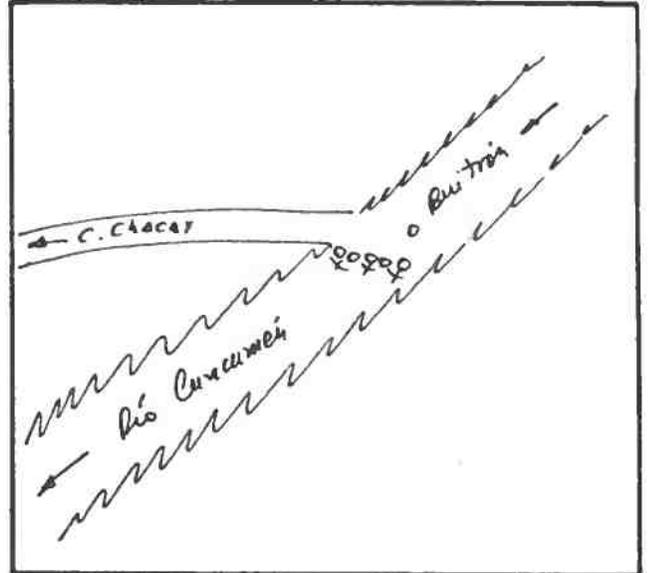
DESCRIPCION DE LA BOCATOMA Con barrera de piedra y patas de cabra se desvía un brazo del río hacia la bocatoma del canal, de tipo provisoria, frente al predio, rol 246-2 de Salamanca.
