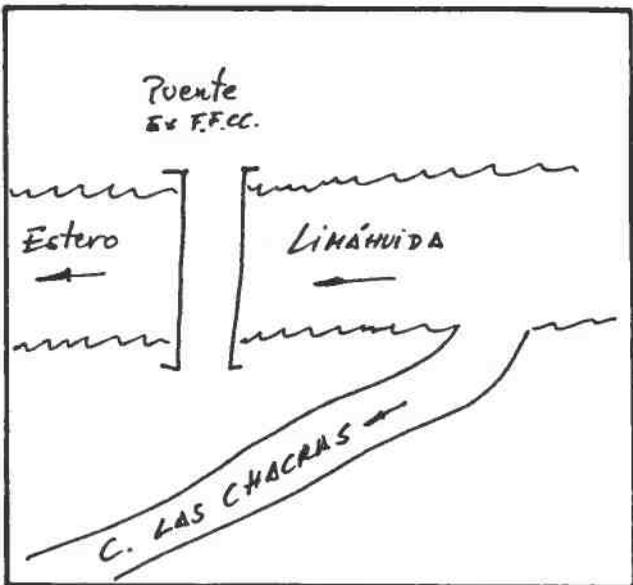
DESCRIPCION DE LA BOCATOMA Con barrera de piedra y patas de cabra se desvía un brazo del Estero hacia la bocatoma del canal, de tipo provisoria, frente al predio rol 421-107 de Illapel.
