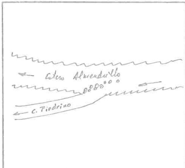
DESCRIPCION DE LA BOCATOMA Con barrera de piedra y patas de cabra se desvía un brazo del Estero hacia la bocatoma del canal, de tipo provisoria, frente al predio rol 247-164 de Salamanca.
