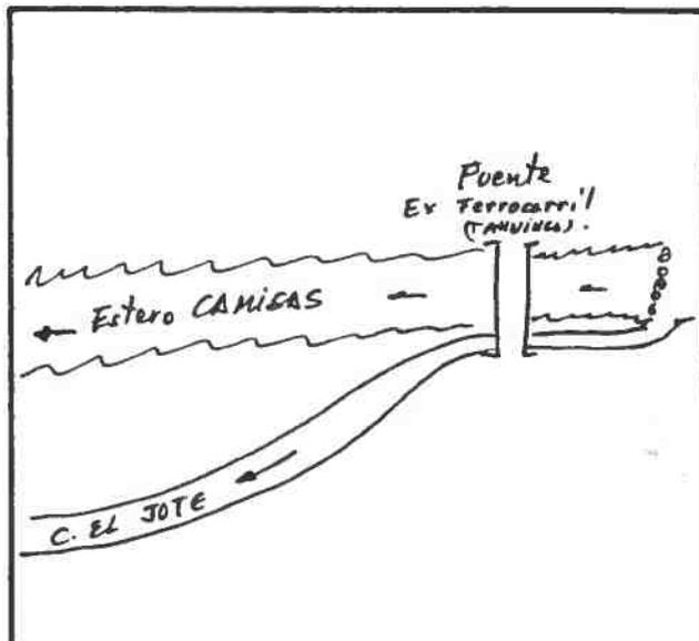
DESCRIPCION DE LA BOCATOMA Con barrera de piedra y patas de cabra se desvía un brazo del Estero hacia la bocatoma del canal, de tipo provisoria, frente al predio rol E.T.Pc.94. de Salamanca.
