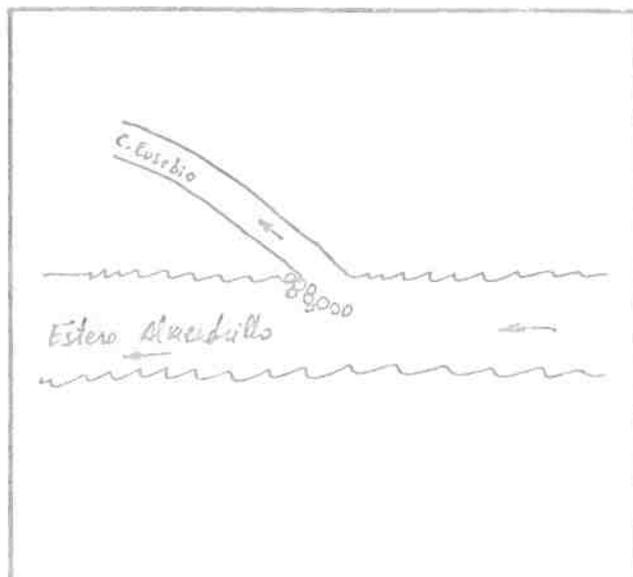
DESCRIPCION DE LA BOCATOMA Con barrera de piedra y patas de cabra se desvía un brazo del Estero hacia la bocatoma del canal, de tipo provisoria, frente al predio rol 247-6 de Salamanca.
