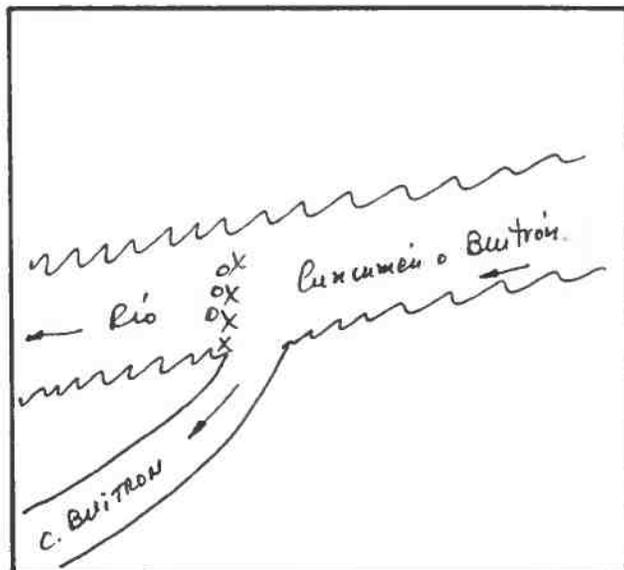
DESCRIPCION DE LA BOCATOMA Con barrera de piedra y patas de cabra se desvía un brazo del río hacia la bocatoma del canal, de tipo provisoria, frente al predio rol 246-10 de Salamanca.
