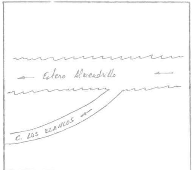
DESCRIPCION DE LA BOCATOMA Con barrera de piedra y patas de cabra se desvía un brazo del Estero hacia la bocatoma del canal, de tipo provisoria, frente al predio rol 247-163 de Salamanca.
