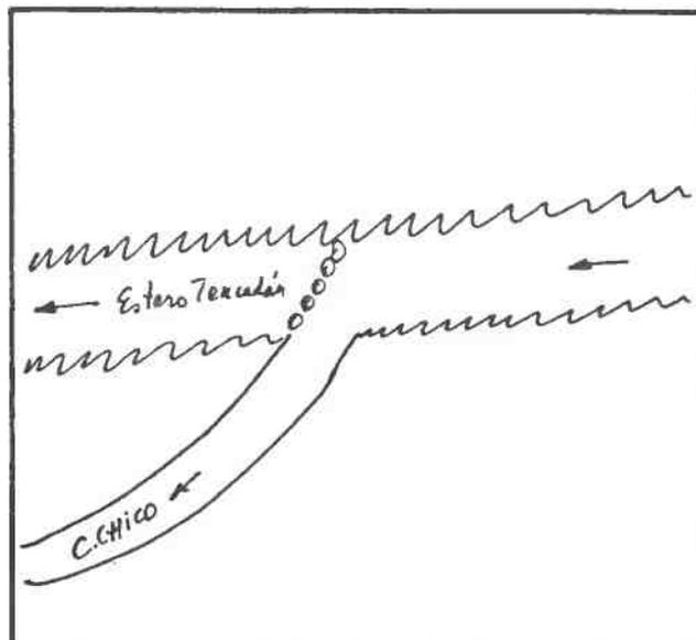
DESCRIPCION DE LA BOCATOMA Con barrera de piedra y patas de cabra se desvía un brazo del Estero hacia la bocatoma del canal, de tipo provisoria, frente al predio del canal, rol 246-1 de Salamanca.
