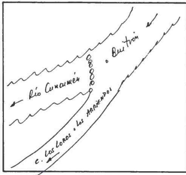
DESCRIPCION DE LA BOCATOMA Con barrera de piedra y patas de cabra se desvía un brazo del río hacia la bocatoma del canal, de tipo provisoria, frente al predio rol 246-58 de Salamanca.
