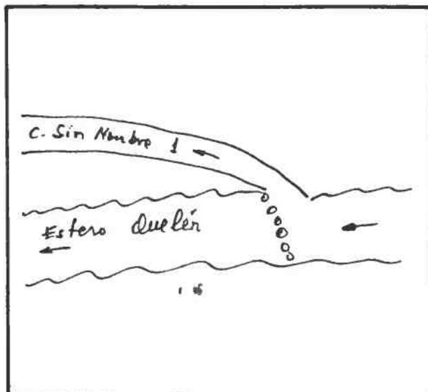
DESCRIPCION DE LA BOCATOMA Con barrera de piedra y patas de cabra se desvía un brazo del Estero hacia la bocatoma del canal, de tipo, provisoria, frente al predio rol 249-129 de Salamanca.
