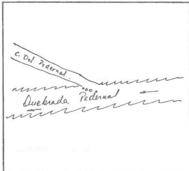
DESCRIPCION DE LA BOCATOMA Con barrera de piedra y patas de cabra se desvía un brazo de la Quebrada hacia la bocatoma del canal, de tipo provisoria, frente al predio rol 247-163 de Salamanca.
