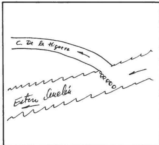
DESCRIPCION DE LA BOCATOMA Con barrera de piedra y patas de cabra se desvía un brazo del Estero hacia la bocatoma del canal, de tipo provisoria, frente al predio rol 249-171 de Salamanca.
