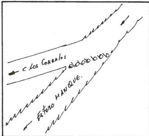
DESCRIPCION DE LA BOCATOMA Con barrera de piedra y patas de cabra se desvía un brazo del estero hacia la bocatoma, del canal de tipo provisoria, frente al predio rol 245-1 de Salamanca.
