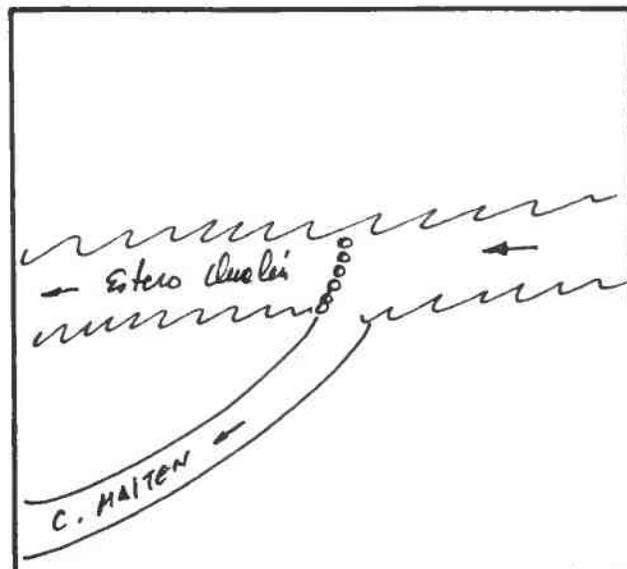
**DESCRIPCION DE LA BOCATOMA** Con barrera de piedra y patas de cabra se desvía un brazo del Estero hacia la bocatoma del canal, de tipo provisoria, frente al predio rol 249-158 de Salamanca.
