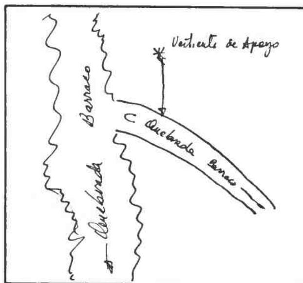
DESCRIPCION DE LA BOCATOMA Con barrera de piedra y patas de cabra se desvía un brazo de la Quebrada hacia la bocatoma del canal, de tipo provisoria, frente al predio rol 245-74 de Salamanca.
