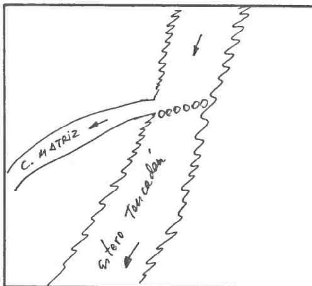
DESCRIPCION DE LA BOCATOMA Con barrera de piedra y patas de cabra se desvía un brazo del Estero hacia la bocatoma del canal, de tipo provisoria, frente al predio rol 246-1 de Salamanca.
