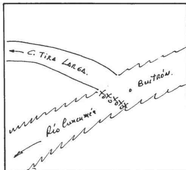
DESCRIPCION DE LA BOCATOMA Con barrera de piedra y patas de cabra se desvía un brazo del río hacia la bocatoma del canal, de tipo, provisoria, frente al predio rol 246-15 de Salamanca.
