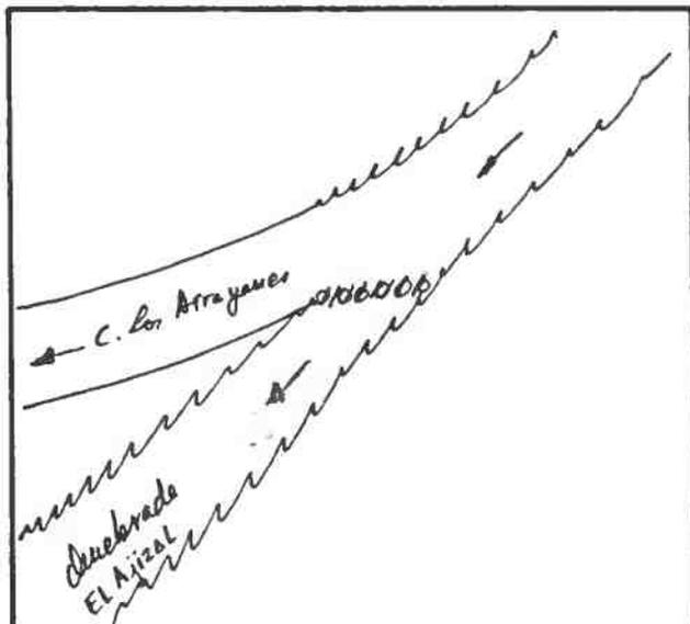
DESCRIPCION DE LA BOCATOMA Con barrera de piedra y patas de cabra se desvía un brazo de la Quebrada hacia la bocatoma del canal, de tipo provisoria, frente al predio rol 245-1 de Salamanca.
