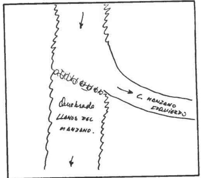
**DESCRIPCION DE LA BOCATOMA** Con barrera de piedra y patas de cabra se desvía un brazo de la Quebrada hacia la bocatoma del canal, de tipo provisoria, frente al predio, rol 246-74 de Salamanca.
