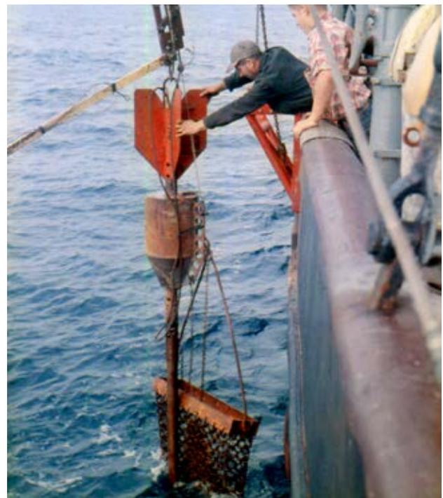
Piston Corer, a bordo del RV *Vema*, para obtener testigos geológicos de los sedimentos marinos y rastra.
