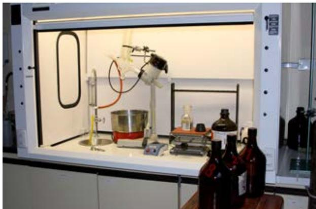
En el laboratorio oceanográfico del SHOA se realizan los procesos analíticos para determinar la contaminación por petróleo.
