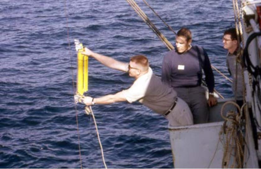
A bordo del RV *Horizon*, colocación de botella Nansen para obtener muestras de agua a profundidades predeterminadas y medir temperaturas.
