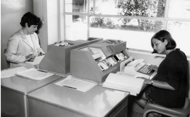
Máquinas perforadoras de tarjetas.
