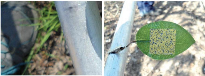
**Figura 8.3.** Uso de papeles hidrosensibles para comprobación de cubrimiento. (Izquierda) Antes de la pulverización. (Derecha) Después de pulverización.
