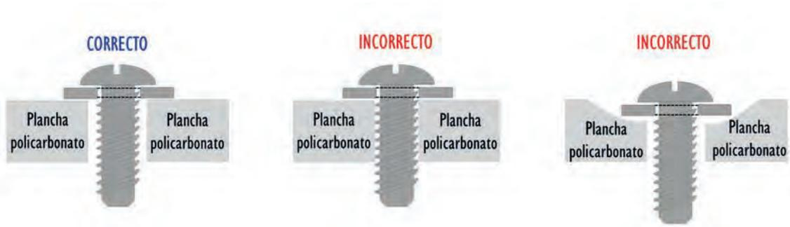
**Figura9:** Esquema de la correcta e incorrecta perforación e instalación de tornillos con golilla de goma en planchas de policarbonato. Izquierda, espacio para la dilatación de la plancha. Centro, orificio reducido sin espacio para dilatación de la plancha. Derecha, plancha aplastada por exceso de apriete del tornillo (Fuente: Elaboración propia).
