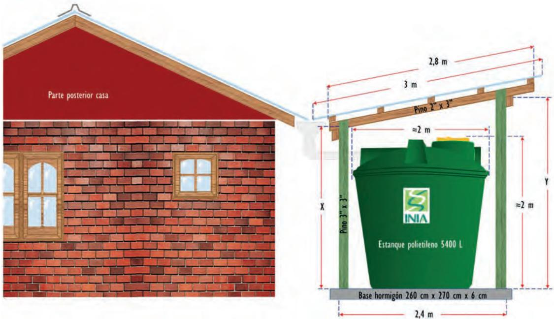
**Figura 13:** Esquema de instalación de estanque de acumulación sobre radiador y bajo techo de una caída de agua. (Fuente: Elaboración propia).
