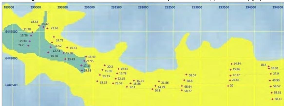
Con los antecedentes mencionados, se elaboró una representación volumétrica del relleno acuífero, la que fue incorporada al modelo de flujo subterráneo. El contacto roca-relleno fue trazado usando la información topográfica (ráster SRTM<sup>23</sup>), la geofísica y el catastro de captaciones subterráneas realizado en el área. En la Figura 8.1-6 se muestra la extensión del relleno en planta, incorporada al modelo de flujo subterráneo.
