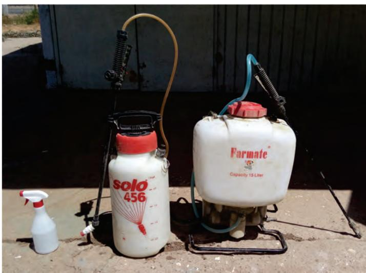
**Figura 33.** Pulverizadores que pueden ser utilizados para la aplicación de solución cal-agua.
