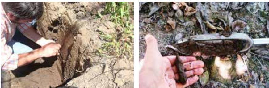
**Figura 4.6.** Monitoreo de humedad de suelo mediante barreno y calicatas.
