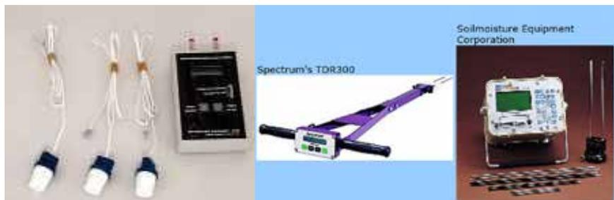
**Figura 4.5.** Izquierda. Bloques de yeso. Derecha. Sensores de capacitancia.
