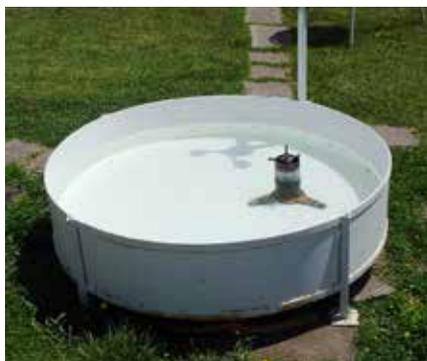
**Figura 4.3.** Izquierda. Esquema de las dimensiones de un evaporímetro de bandeja Clase A. Derecha. Evaporímetro de bandeja Clase A ubicado en terreno.
