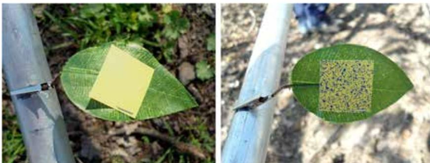
**Figura 9.5.** Uso de papeles hidrosensibles para comprobación de cubrimiento. Izquierda) Antes de la pulverización. Derecha) Después de pulverización con cubrimiento adecuado.
