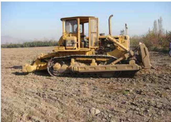
**Figura 3.6.** Tractor sobre orugas o "Bulldozer" con subsolador, apropiado para labores profundas en suelos secos o con bajo contenido de humedad. Fundo El Coigue, Requínoa.
