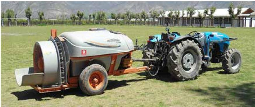
**Figura 9.2.** Pulverizador hidroneumático para aplicaciones de plaguicidas en frutales.
