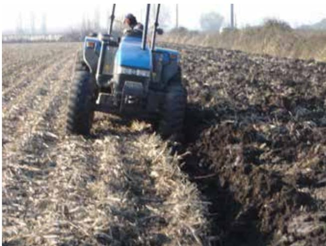
**Figura 3.2.** Labor de aradura con tractor y arado de vertedera. Obsérvese las ruedas de un lado del tractor, en el interior del último surco de aradura.
