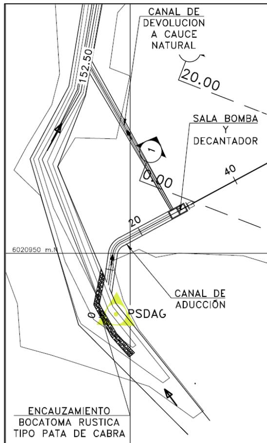
Figura 14.4-1 Ejemplo de Esquema de Obra de Captación
