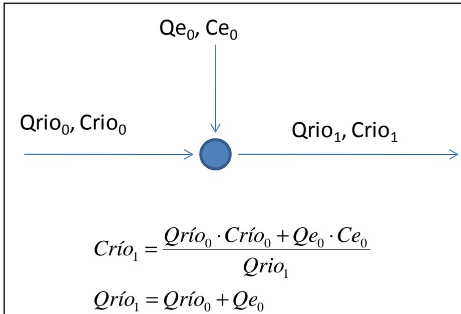
**Figura 6-1 : Diagrama Calculo de Concentracion Final despues de una Descarga**
