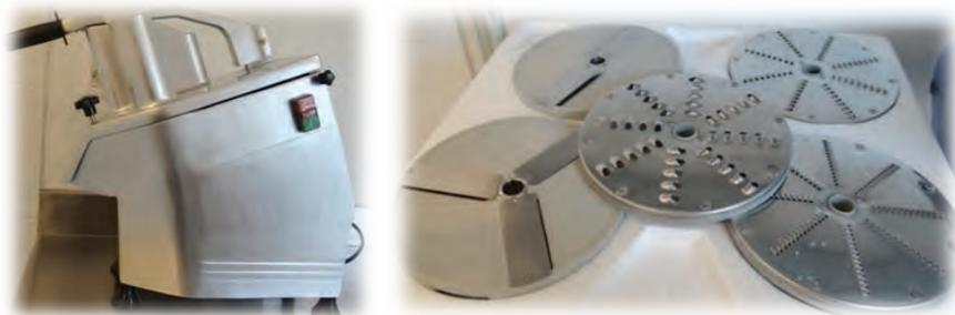
Figura 1. Máquina procesadora de hortalizas mediante discos de cortes o rallados
