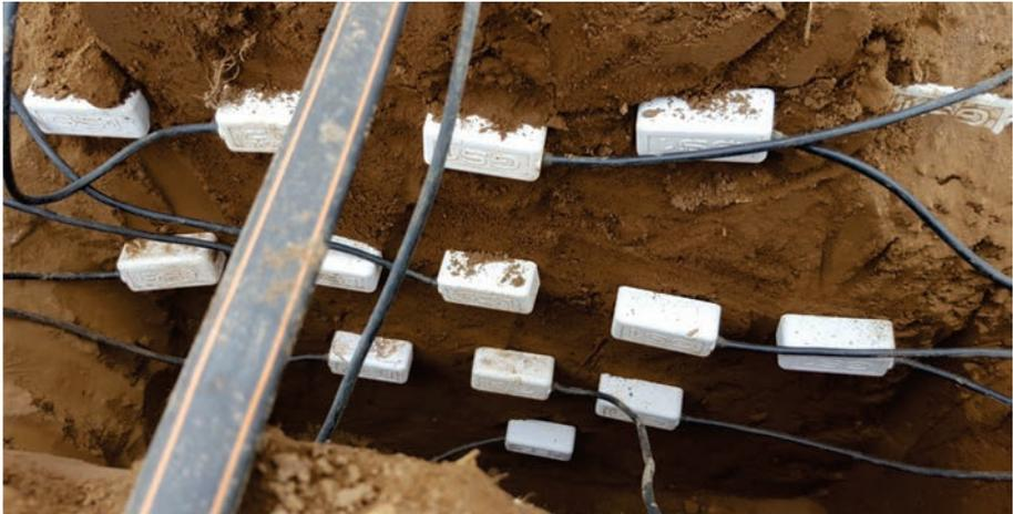
**Figura 7.3.** Sensores de humedad de suelo instalados en la zona del bulbo húmedo creado por el riego por goteo en Parcela Experimental Pan de Azúcar, INIA, Región de Coquimbo.
