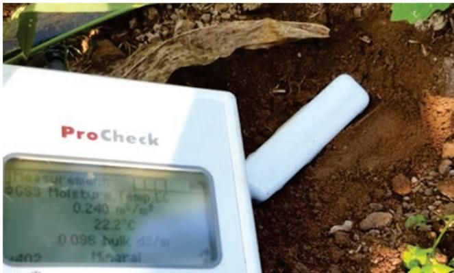
**Figura 7.4.** Sensores de humedad y salinidad de suelos franco, en Parcela Experimental Pan de Azúcar, INIA, Región de Coquimbo.
