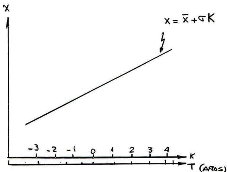
Como ejemplo del procedimiento se indica a continuación el Método de Gumbel para ajustar funciones de frecuencia acumulada en el caso de una distribución extrema.
