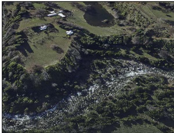
Figura 11.1-8. DTM como nube de puntos con color RGB
