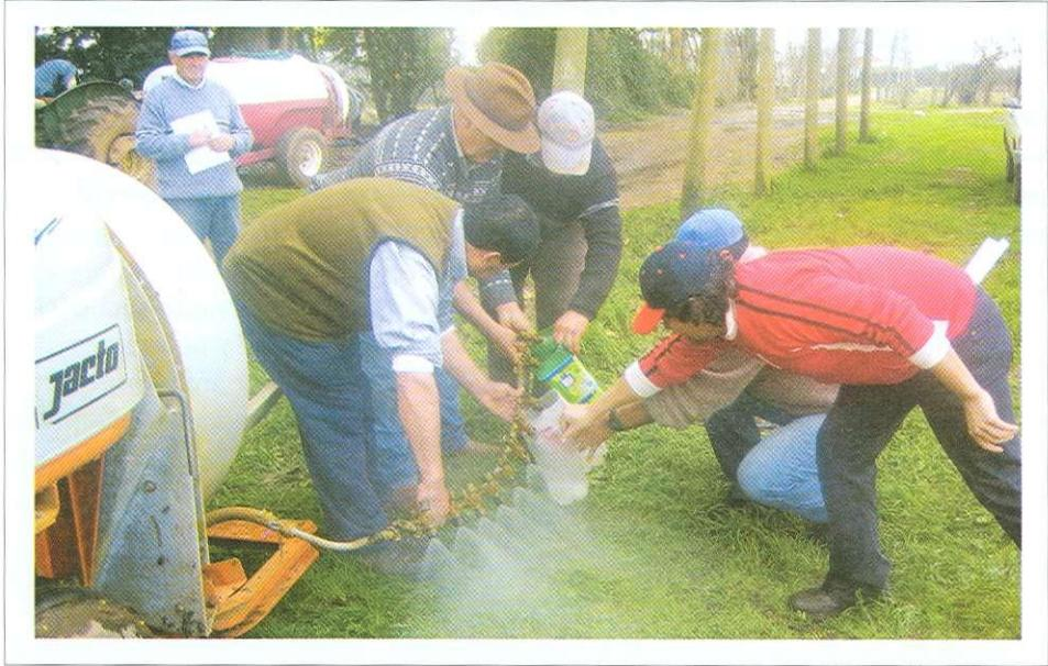
**Foto 4.** Capacitación: Agricultores del GTT Frutales Cumpeo, Región del Maule, se capacitan unidos en calibración de equipo nebulizador.
