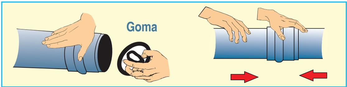
**Figura 24. Método de unión de tuberías mediante acople con anillo Anger**
