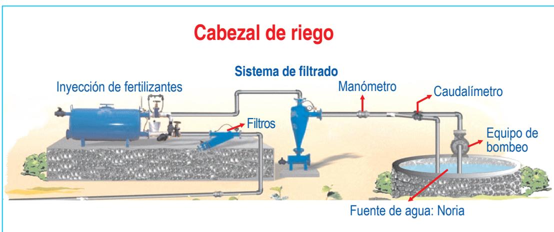
Figura 3. Componentes de un cabezal de riego tecnificado
