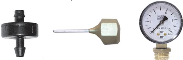
Figura 35. Elementos de medición de presión en goteros
