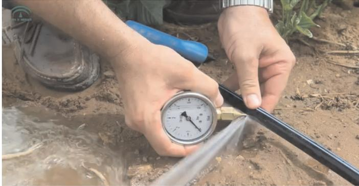
Figura 34. Aforo de emisor de riego
