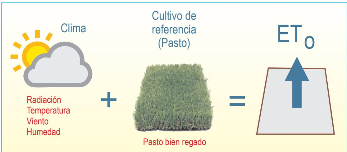
**Figura 9. Determinación de la evapotranspiración de referencia ( $ET_0$ )**
