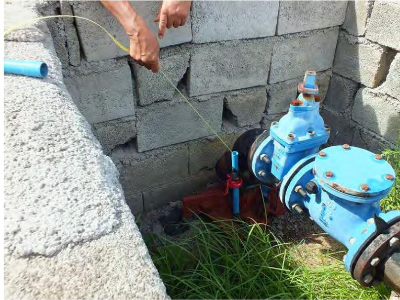
**Figura 2.18-2** Midiendo nivel del agua en pozo 23
