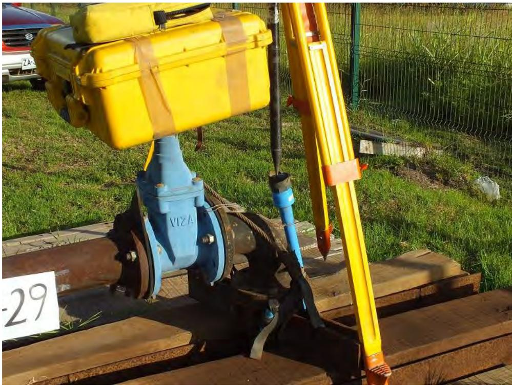
**Figura 2.5-3 Detalle posición diver pozo 29**
