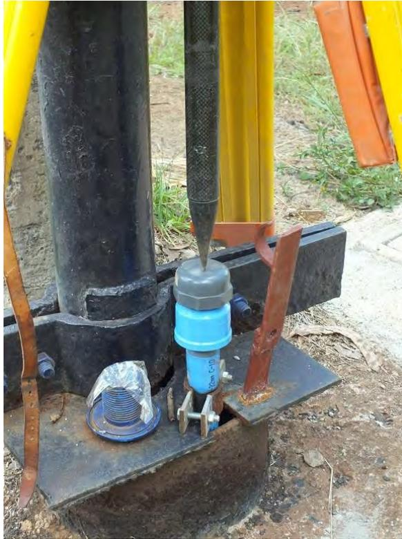
**Figura 2.3-2 Detalle posición diver pozo 27**
