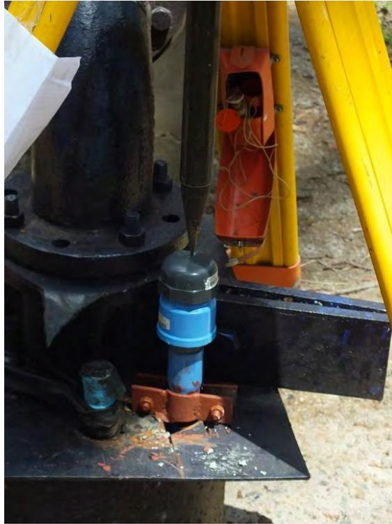
**Figura 2.2-2 Detalle posición tapa diver pozo 28**
