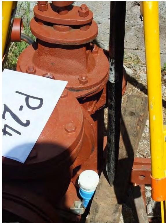
**Figura 2.6-4 detalle de posición diver pozo 24**
