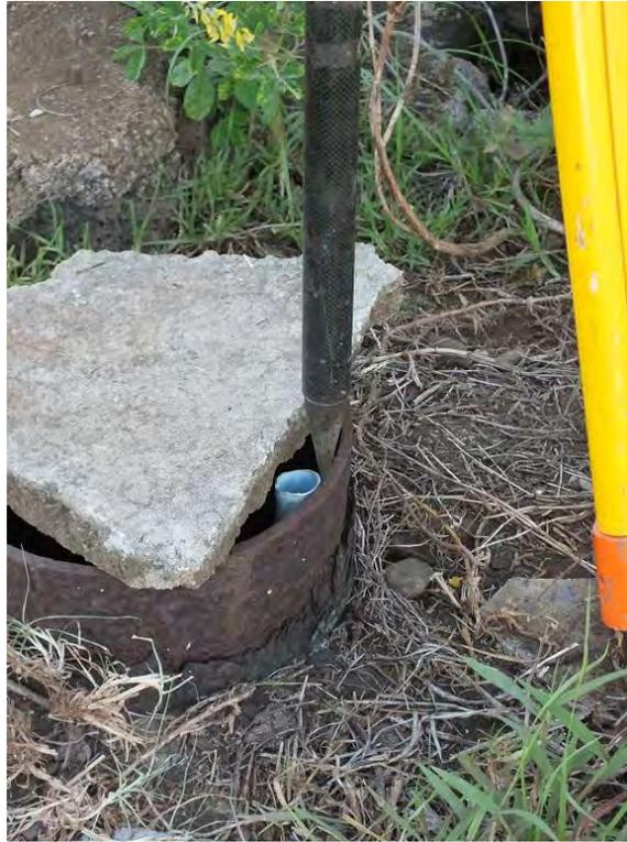
**Figura 2.17-2 detalle posición línea de aire pozo 14**
