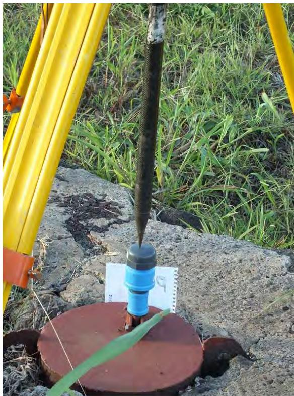
**Figura 2.16-3 detalle posición del diver pozo 13**
