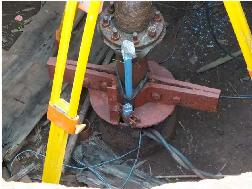
**Figura 2.10-1 Vista general de base de diver y línea de aire pozo 21**
