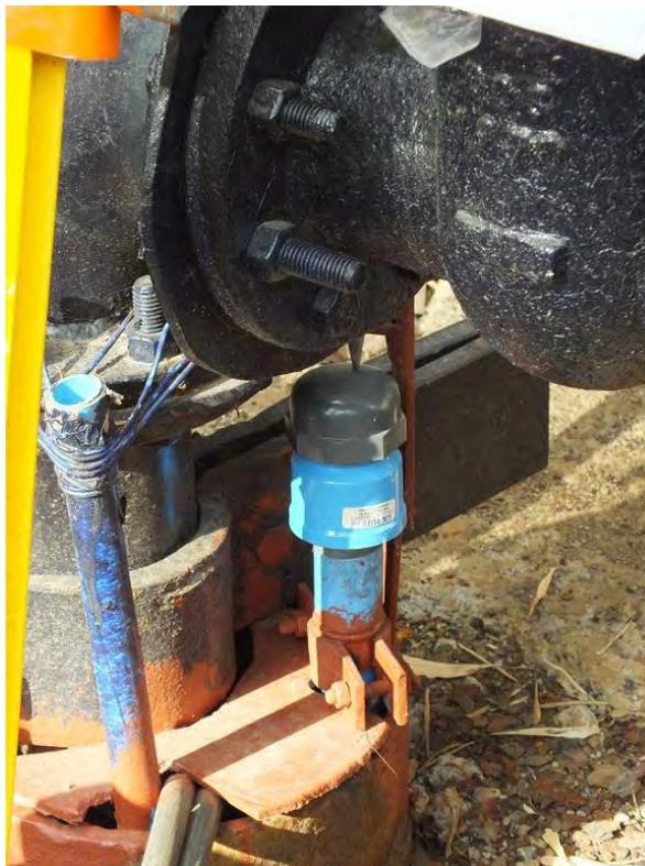
**Figura 2.4-3 Detalle de posición Diver pozo 25**
