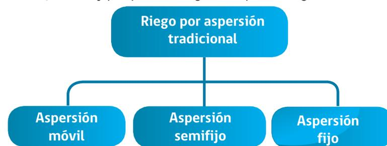
Figura 12. Clasificación de sistemas de riego por aspersión.
