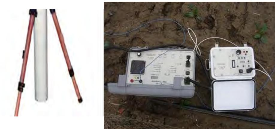
Figura 55. Antena TEM-3 (izquierda) y transmisor ZT-30 (derecha)
