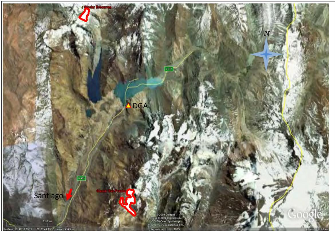
Figura 2: Imagen de referencia general de las dos áreas levantadas, marcadas en color rojo y el vértice geodésico DGA utilizado como estación base.
