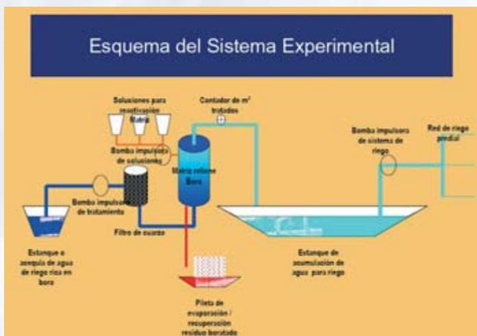
Esquema que muestra el sistema de abatimiento de B propuesto por la U. de Tarapacá.
