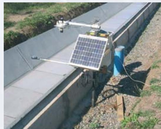
Canal de ensayo de la fotocatalisis en el que se mide los niveles de radiación obtenidos.
