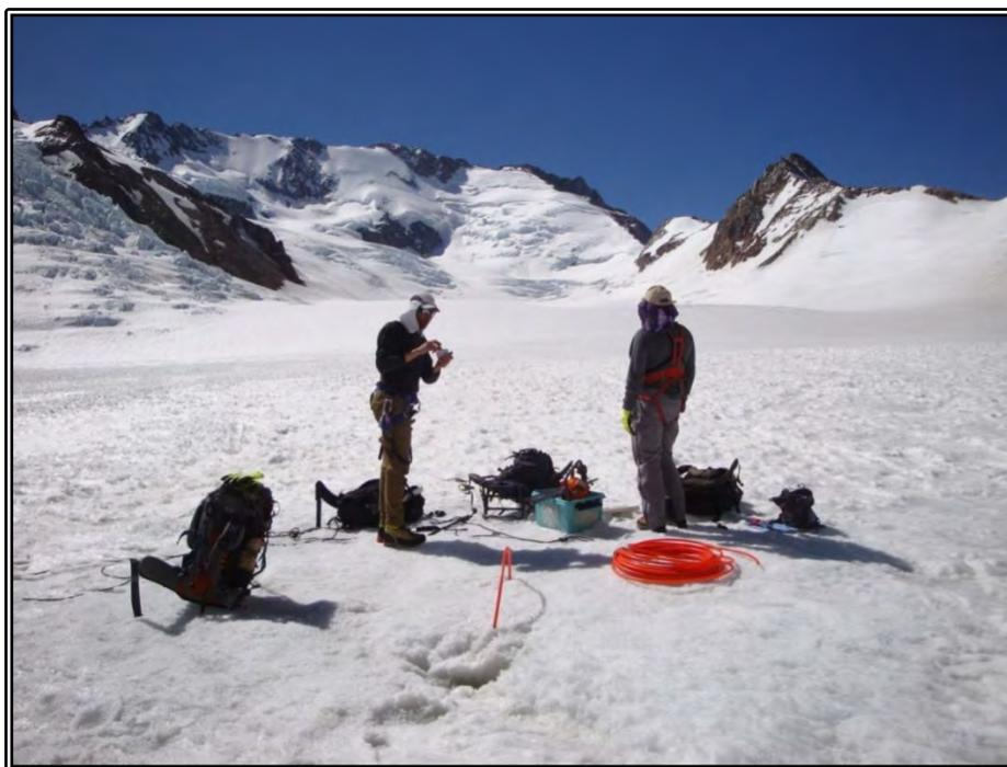
**Figura 4.4.1.3-C. Baliza de ablación instalada en la cuenca Norte del glaciar Universidad.**
