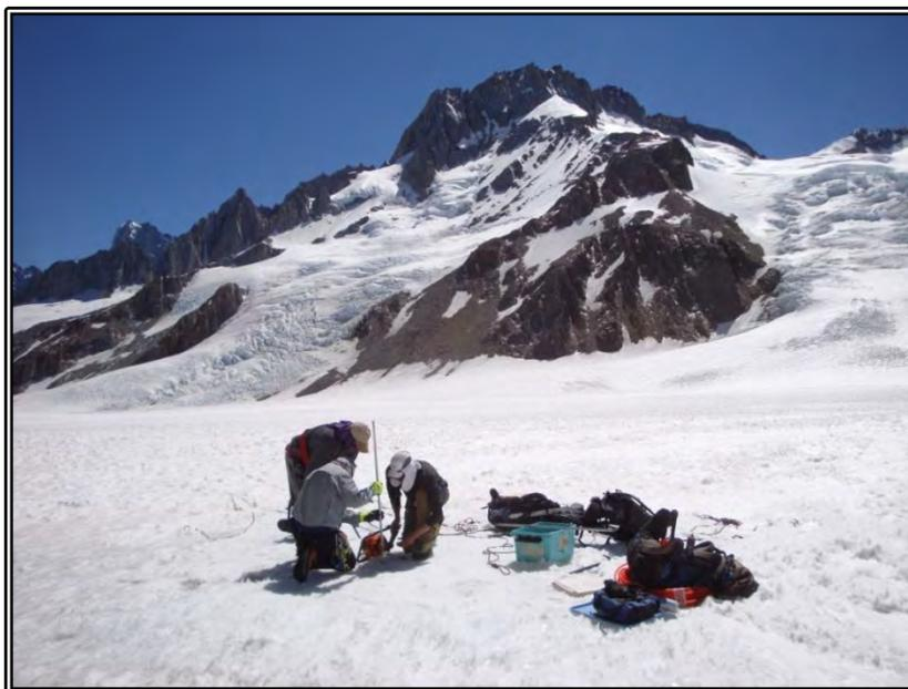
**Figura 4.4.1.3-B. Trabajos de perforación del hielo con taladro mecánico en la cuenca Norte del glaciar Universidad.**
