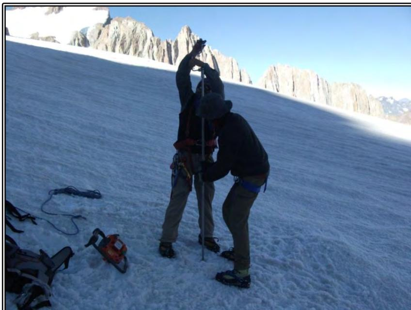
**Figura 4.4.1.3-I. Perforación manual con taladro para la reinstalación de baliza en cuenca Oeste del glaciar Universidad.**
