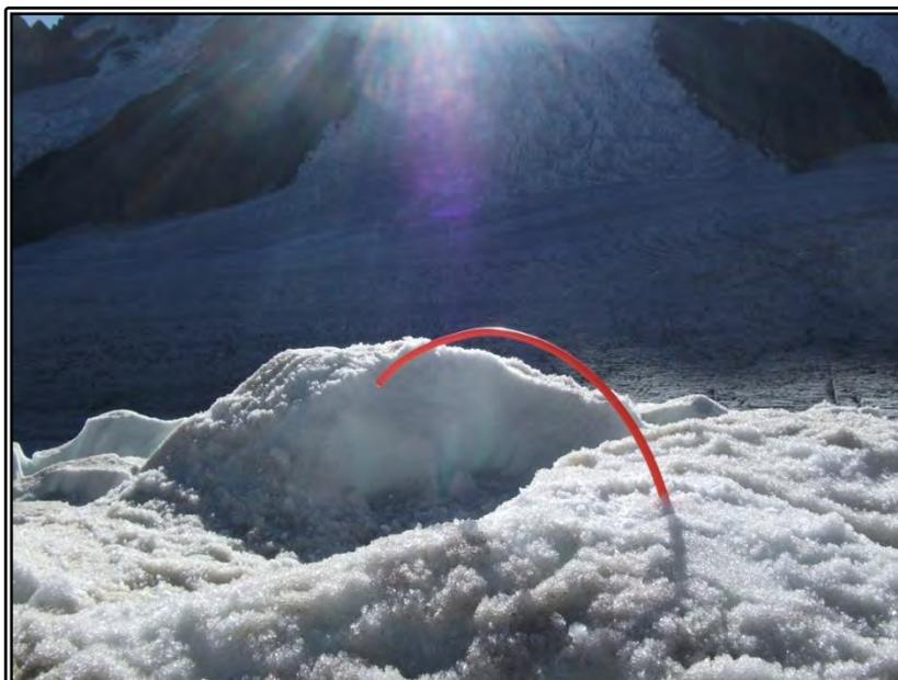
**Figura 4.4.1.2-C. Apariencia de una baliza flexible de PVC, instalada en el hielo.**
