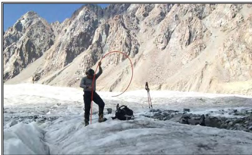
**Figura 4.4.1.2-B. Insertando una baliza en el sondaje previamente realizado.**
