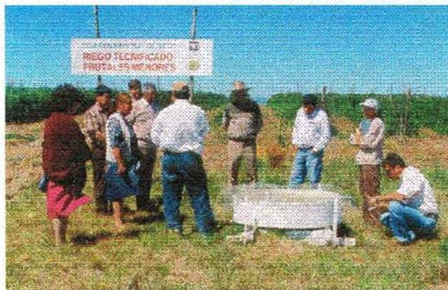
*Utilización y aplicación de badeja de evaporación correcta clase A en la programación del riego.*
