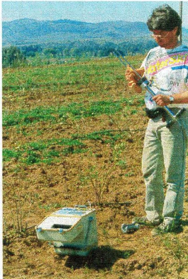
**Figura 2 :** Uso de Time Domain Reflectometry (TDR) para monitorear la humedad del suelo.
