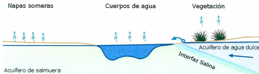
Figura 5.1.2.2. Modelo conceptual del funcionamiento del margen de un salar
