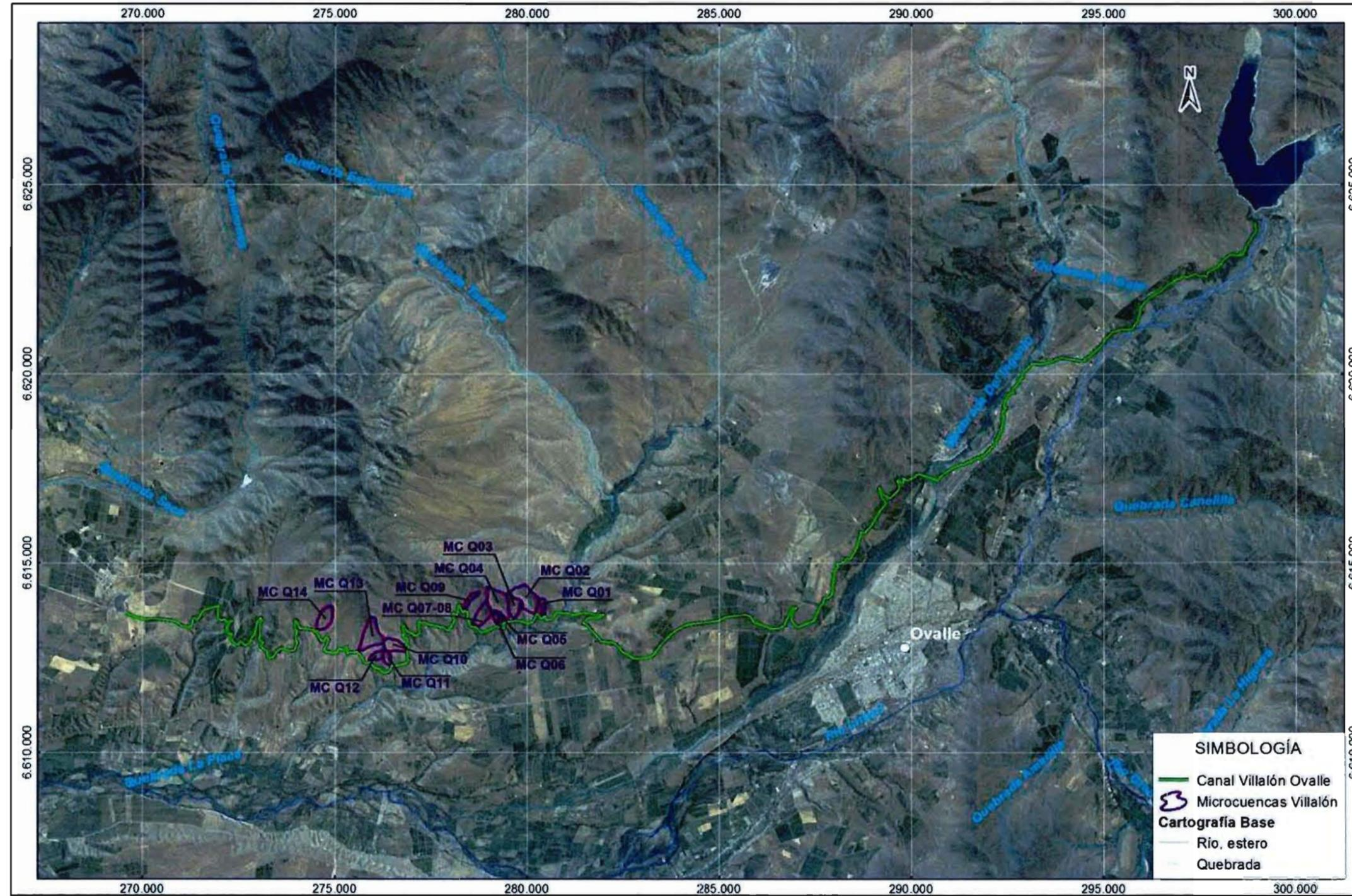
En la Tabla 4-3 se indica la estimación de caudales de las quebradas afluentes al canal Villalón utilizando el método racional (los detalles morfológicos de la cuenca se adjuntan en el Anexo 9.3). Los cálculos se realizaron para distintos periodos de retorno.
