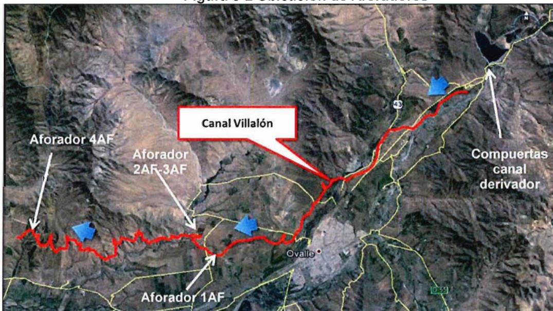
Se observa que las obras de medición de caudales en el canal Villalón se encuentran en óptimas condiciones, el cual además dispone de un sistema de medición remoto de caudales.
