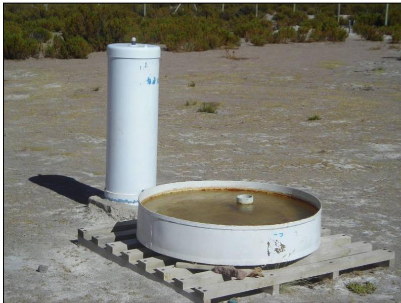
Figura 4.3: Tanque Evaporímetro Clase A.
