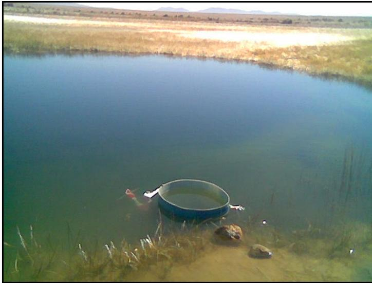
Figura 5.8. Sistema de medición implementado para la estimación de la evaporación superficial en cuencas sin evaporímetros.
