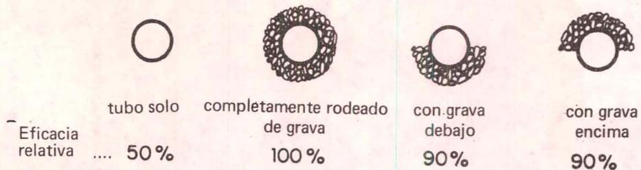
Fig. A2-4 DIVERSOS TIPOS DE CONTORNO PARA TUBERIAS DE DRENAJE, ENSAYADOS POR DENNIS Y TRAFFORD (1975), CON INDICACION DE SU EFICACIA RELATIVA EN CUANTO AL ESPACIAMIENTO POSIBLE
