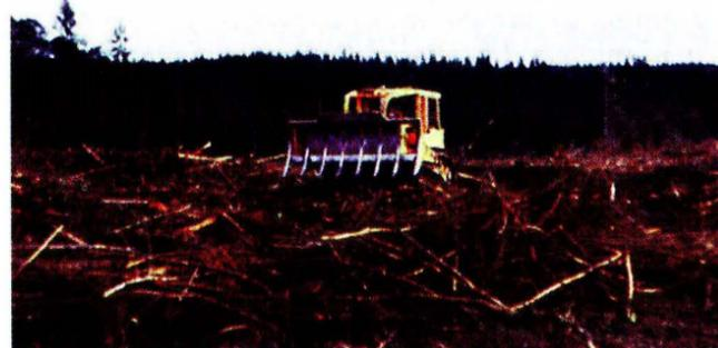
Figura 4: Ordenamiento desechos mecanizado
