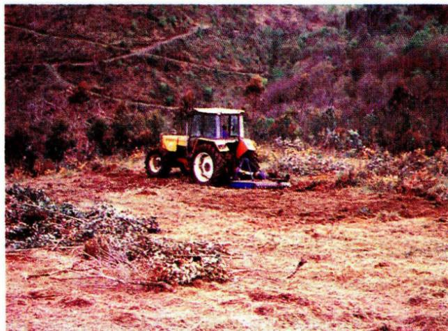
Figura 3: Tractor con mulcher
