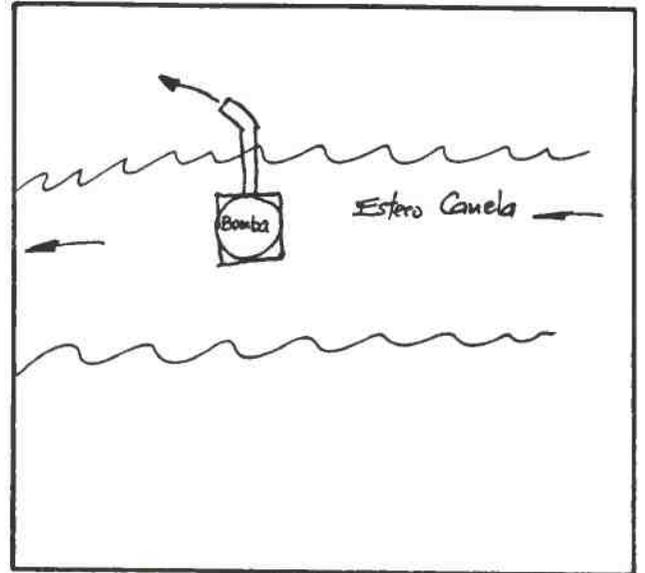
DESCRIPCION DE LA BOCATOMA Mediante excavación poco profunda en el lecho del estero se acopia agua aprovechando la cercanía del acuífero a la superficie, extrayendo el agua mediante una bomba hidráulica. Esto en el predio rol 219-4 de Mincha.
