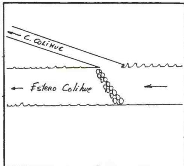
**DESCRIPCION DE LA BOCATOMA** Con barreras de piedras se desvía parte del curso del estero Colihue hacia la bocatoma del canal de tipo provisoria, en el sector correspondiente frente al rol 263-33 de Mincha.
