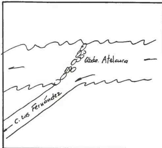
DESCRIPCION DE LA BOCATOMA Con barrera de piedras se desvía el curso de la Quebrada Atelcura hacia la bocatoma del canal, de tipo provisoria, en terrenos del predio rol 267-57 de Mincha.
