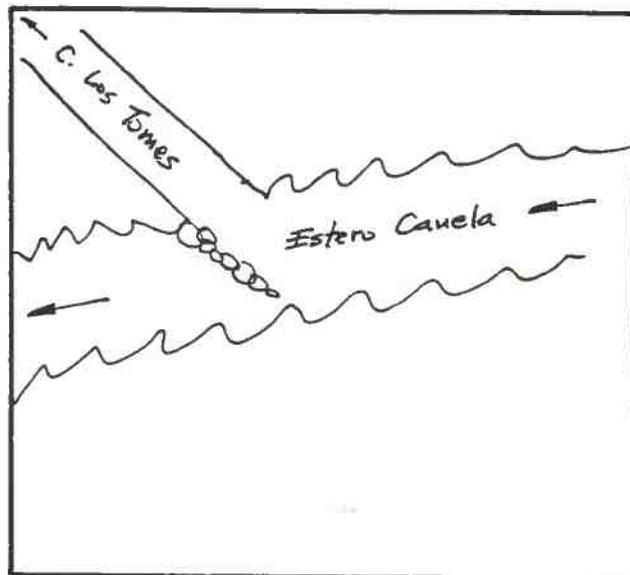
DESCRIPCION DE LA BOCATOMA Con barrera de piedras se desvía parte del curso del Estero Canela hacia la bocatoma del canal, de tipo provisoria, en el sector correspondiente al Fundo Puerto Oscuro, predio rol 219-1 de Mincha.
