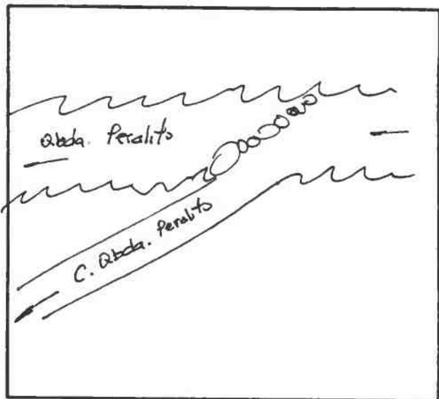
DESCRIPCION DE LA BOCATOMA Con barrera de piedras se desvía parte del curso de la Quebrada Peralito hacia la bocatoma del canal, de tipo provisoria, en terrenos del predio rol 249-7 de Mincha.
