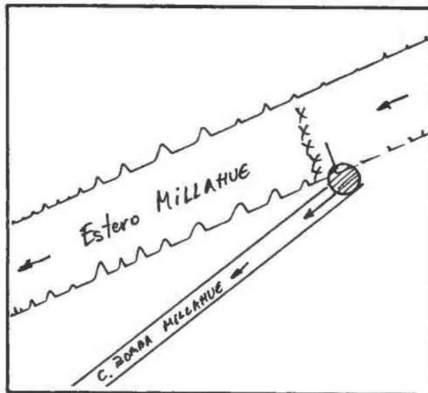
DESCRIPCION DE LA BOCATOMA El canal tiene su origen en la ribera izquierda del Estero Millahue frente al rol 214-2 de Mincha. La bocatoma consiste en una bomba centrífuga de 5" de diámetro con la que se eleva agua hacia los terrenos vecinos.
