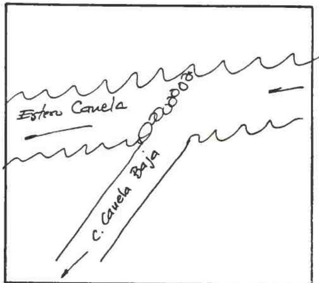
DESCRIPCION DE LA BOCATOMA Con barrera de piedras se desvía parte del cauce del Estero Canela hacia la bocatoma, de tipo provisoria, en el predio, rol 249-7 de Mincha.
