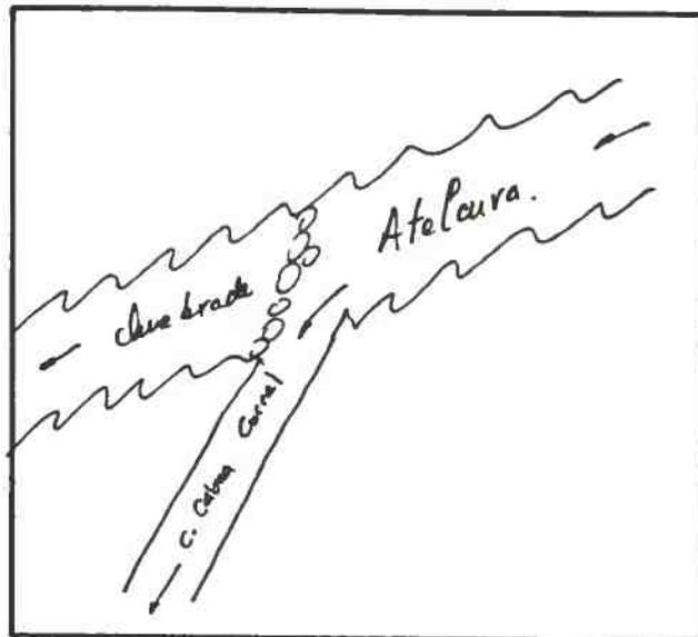
DESCRIPCION DE LA BOCATOMA Con barrera de piedras se desvía parte del curso de la Quebrada Atelcura hacia la bocatoma del canal, de tipo provisoria en el sector correspondiente al predio rol 265-28 de Mincha.
