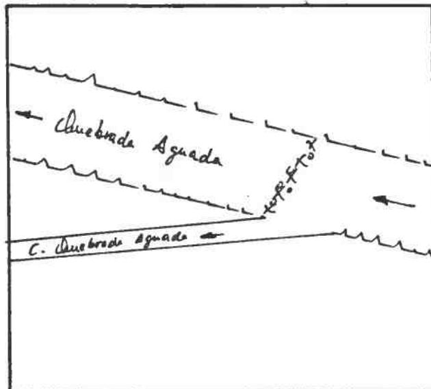
DESCRIPCION DE LA BOCATOMA Con barrera de piedras se desvía el curso de la Quebrada Aguada hacia la bocatoma del canal, de tipo provisoria, en el predio rol 261-34 de Mincha.
