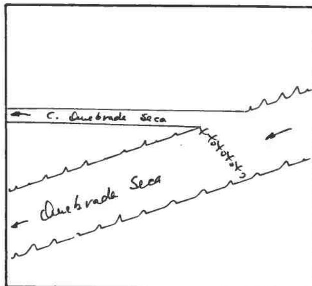
DESCRIPCION DE LA BOCATOMA Con barrera de piedra se desvía el curso de la Quebrada Seca hacia la bocatoma del canal, de tipo provisoria, en el predio rol 263-50 de Mincha.
