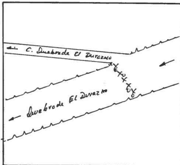
DESCRIPCION DE LA BOCATOMA Con barrera de piedras se desvía el curso de la Quebrada El Durazno hacia la bocatoma del canal, de tipo provisoria, en el rol 261-34 de Mincha.
