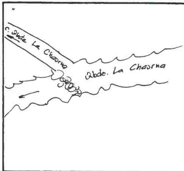
**DESCRIPCION DE LA BOCATOMA** Con barrera de piedras se desvía el curso de la quebrada La Chaorna hacia la bocatoma del canal, de tipo provisoria, en terrenos del predio rol 219-4 de Mincha.
