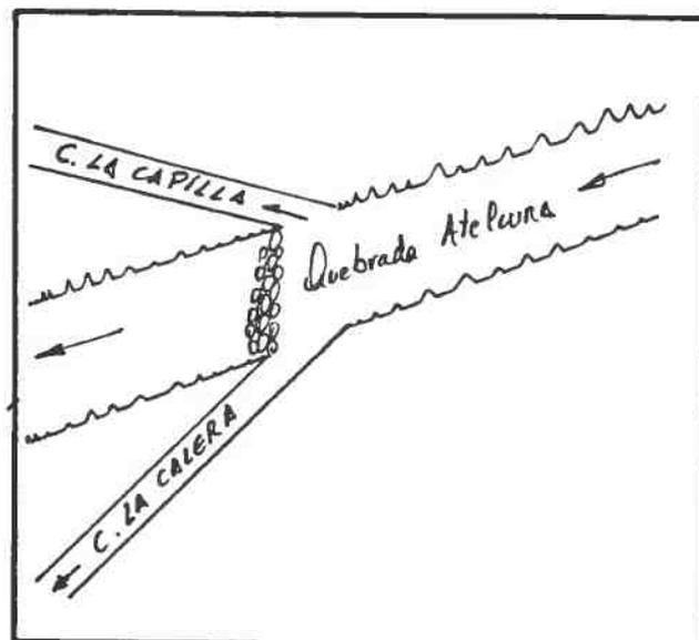
DESCRIPCION DE LA BOCATOMA Con barrera de piedras se desvía el curso de la Quebrada hacia la bocatoma del canal, de tipo provisoria en terreno del predio rol 266-2 de Mincha.
