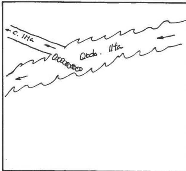
DESCRIPCION DE LA BOCATOMA Con barrera de piedras se desvía el curso de la Quebrada hacia la bocatoma del canal, de tipo provisoria en terrenos del predio rol 270-72 de Mincha.
