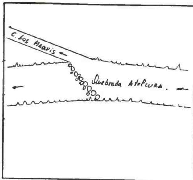
DESCRIPCION DE LA BOCATOMA Con barrera de piedras se desvía el curso de la Quebrada hacia la bocatoma del canal, de tipo provisoria en terrenos del predio rol 265-35 de Mincha.
