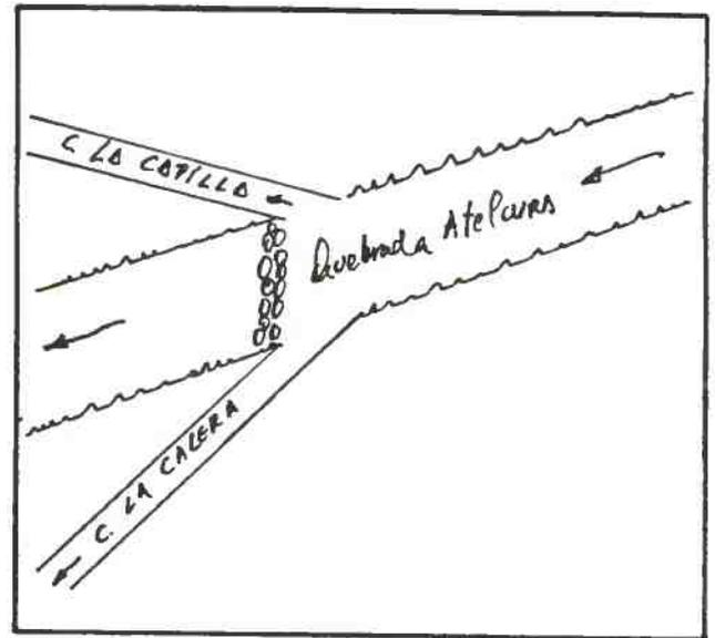
DESCRIPCION DE LA BOCATOMA Con barrera de piedra se desvía el curso de la Quebrada Atelcura hacia la bocatoma del canal, de tipo provisoria, en terrenos del predio rol 265-2 de Mincha.
