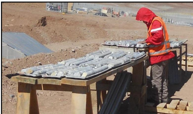
**Figura 2-3 Fotografía de testigos obtenidos con una sonda diamantina**
