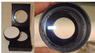
Determinación de la blancura obtenida en el proceso de elaboración. Previo a la toma de notas se debe realizar la calibración del equipo, mediante cápsulas testigos provistas para tal efecto. Es necesario mantener los vidrios limpios, para no alterar las lecturas.
