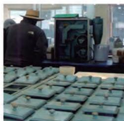
Horno de secado de muestras para calidad industrial. (Previo al proceso de elaboración, la muestra debe tener un reposo. Nunca elaborar la muestra inmediatamente después de secada).
