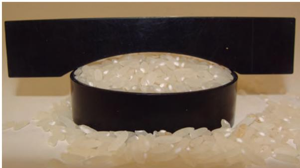
**Figura 23.** Cápsula utilizada en la determinación de blancura, transparencia y molinado.
