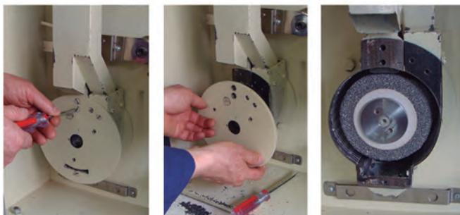
**Figura 17.** Guía esquemática de la calibración del proceso de pulido en el molinito de pruebas.
