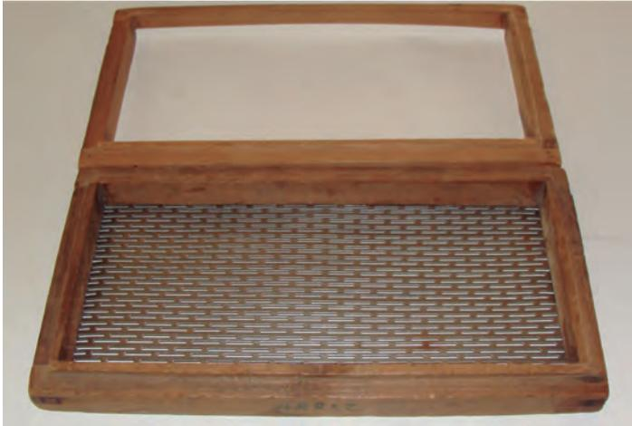
**Figura 13.** Harnero utilizado en la calibración de las muestras de arroz paddy.
