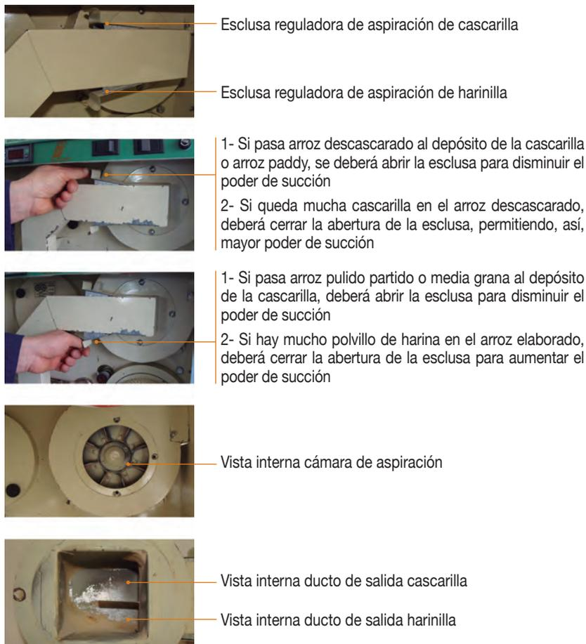
Figura 20. Esquema de la calibración de la cámara de aspiración del molinito de pruebas.
