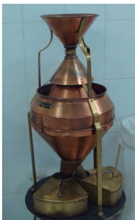
**Figura 9.** Vista de separador de granos requerido en laboratorio de calidad arrocera.
