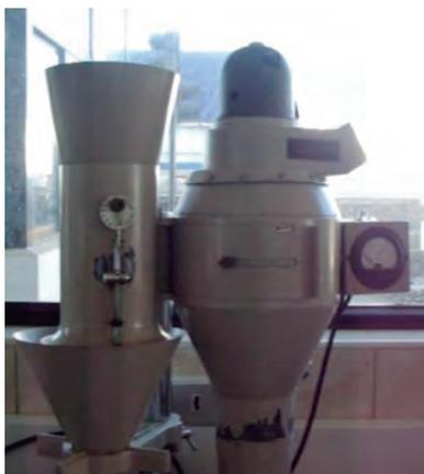
Figura 10. Limpiador de muestras requerido en los laboratorios de calidad arrocerá.
