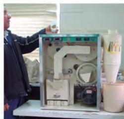
Una vez pesadas las muestras, se debe proceder a su elaboración. El operador debe vaciar la muestra en la tolva de alimentación.
