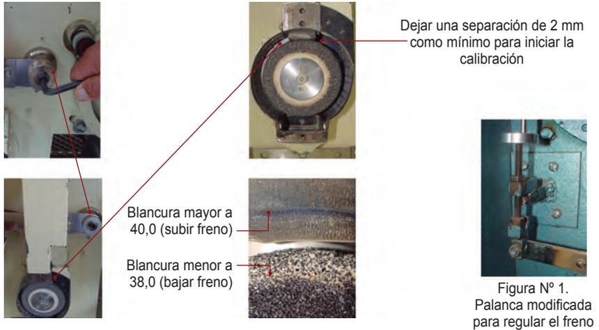
**Figura 19.** Esquema de calibración del proceso de pulido del Molinito de pruebas Suzuki MT.
