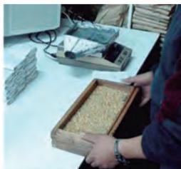
Limpiar la muestra de arroz con harnero 2,0 ovalado con base de fondo, moviéndolo por 60 segundos. En este proceso se dejará una muestra calibrada y limpia, libre de arroses vanos, chupados o cualquier otro material que altere los resultados finales de la calidad industrial.
